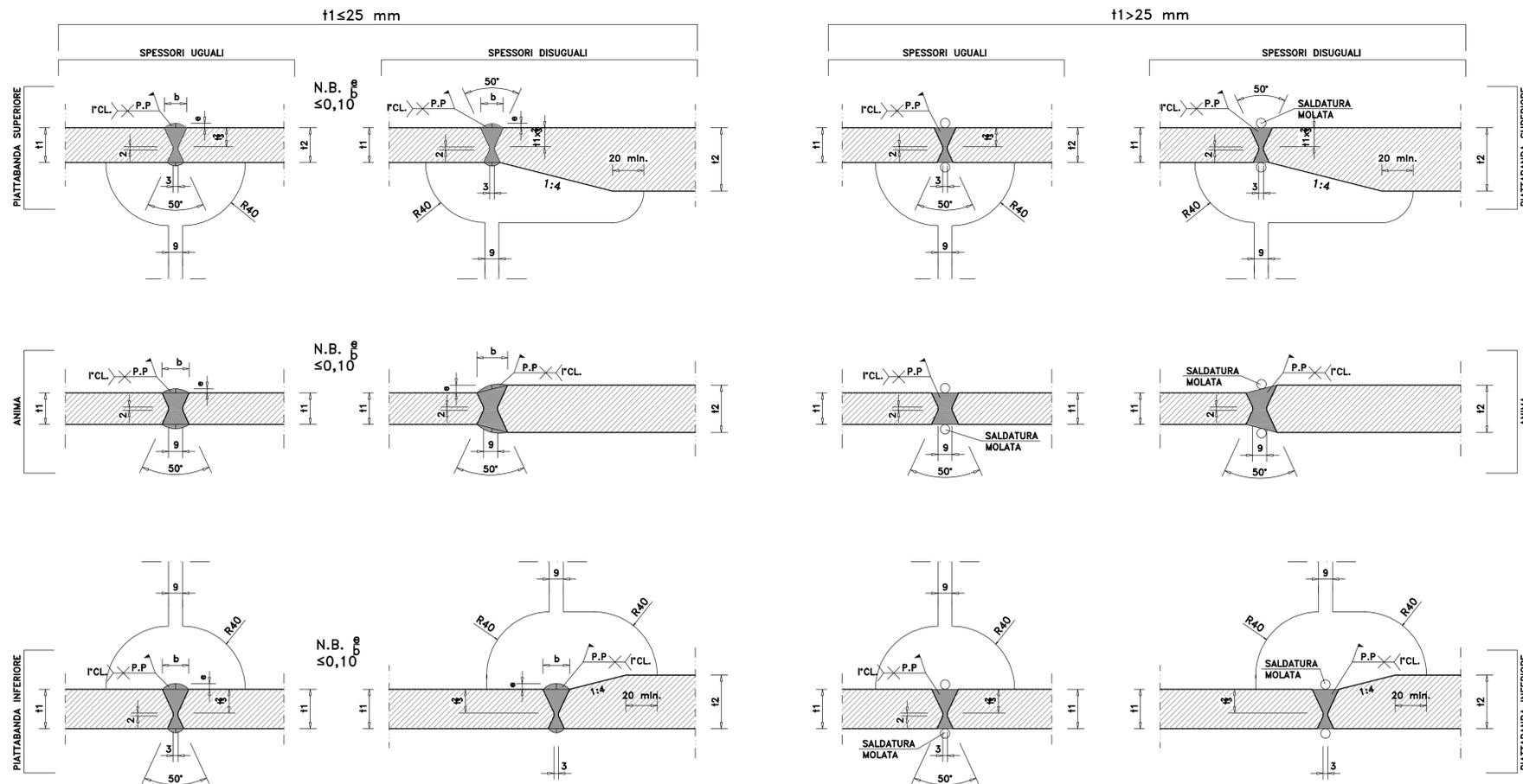
PARTICOLARE ESECUZIONE SALDATURE PIASTRE IMPILATE
