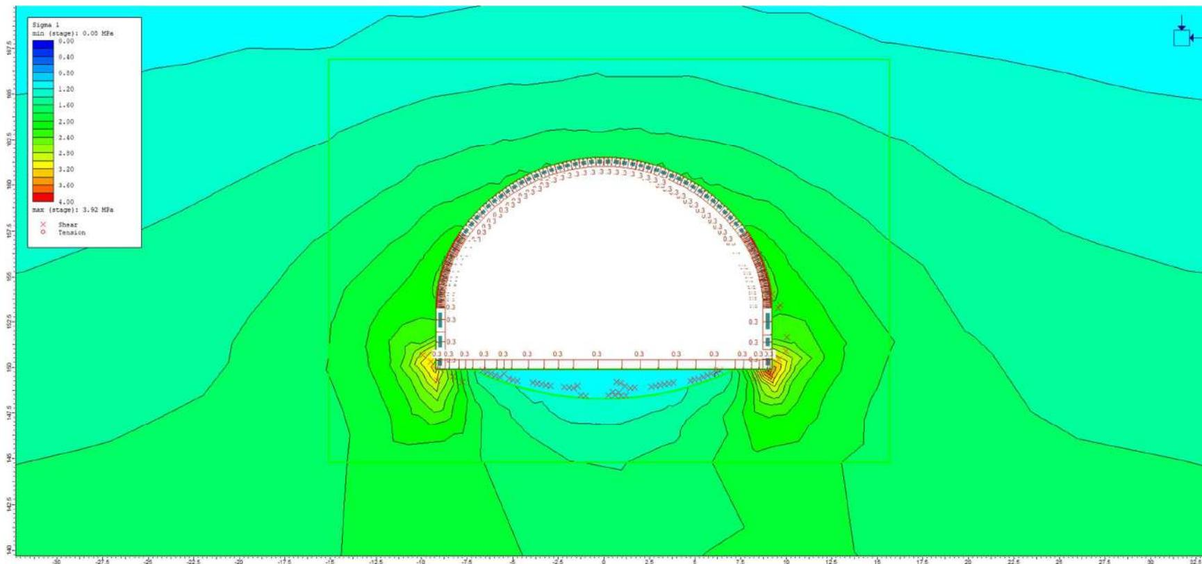
Figura: Fase 10\_Risultati - Sigma 1 + elementi plasticizzati.
