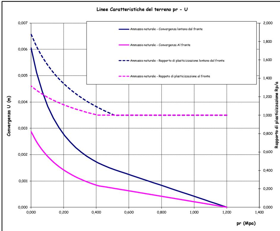
Figura: Linee caratteristiche Bypass carrabile in condizioni naturali \_valori medi.
