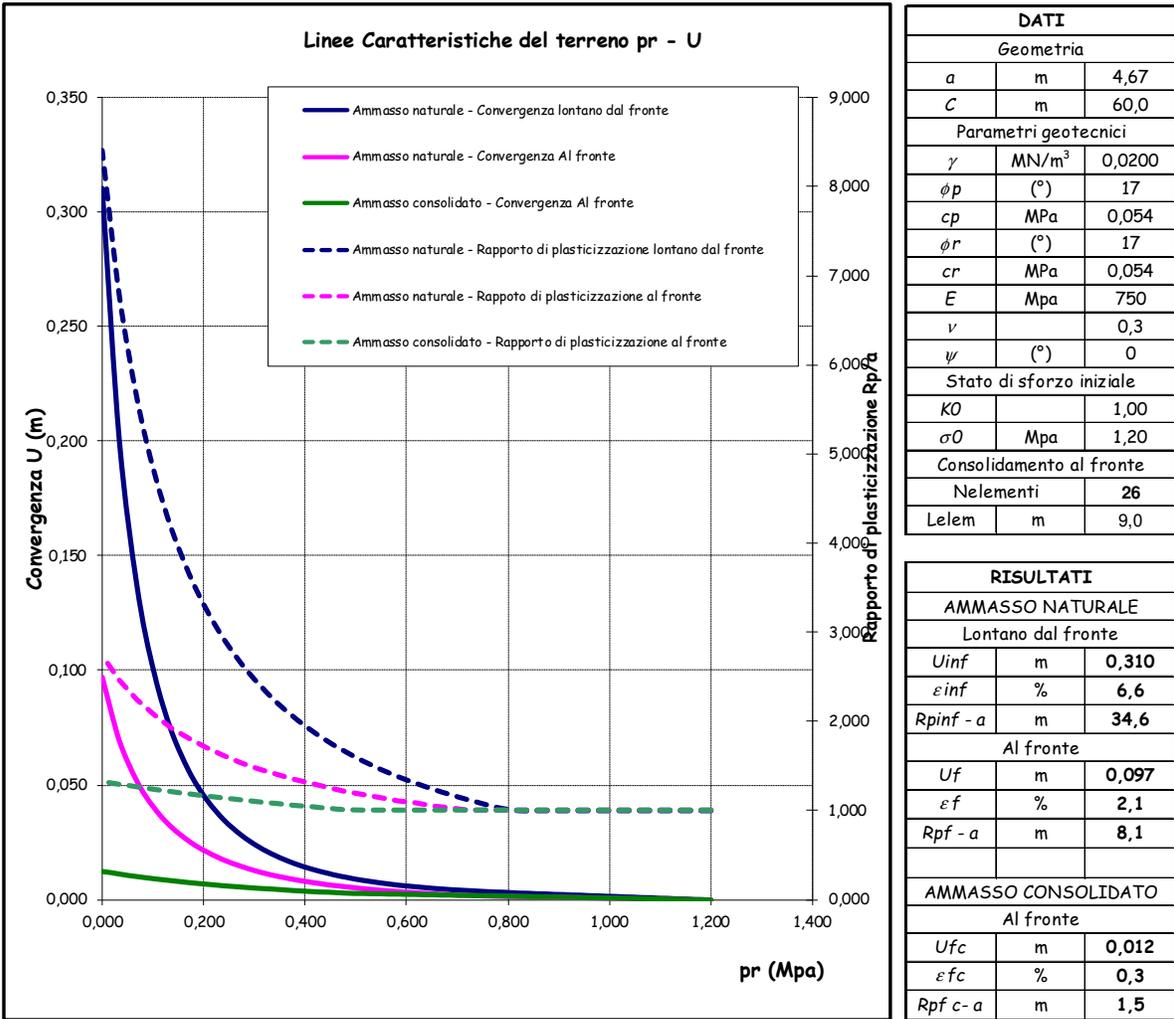
Figura: Linee caratteristiche bypass carrabile con preconsolidamento del fronte.
