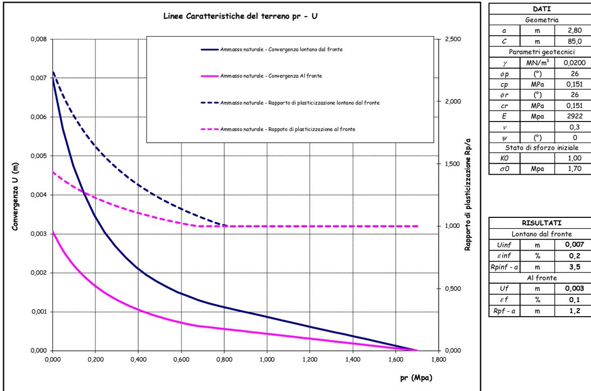
Figura: Linee caratteristiche Bypass pedonali in condizioni naturali.
