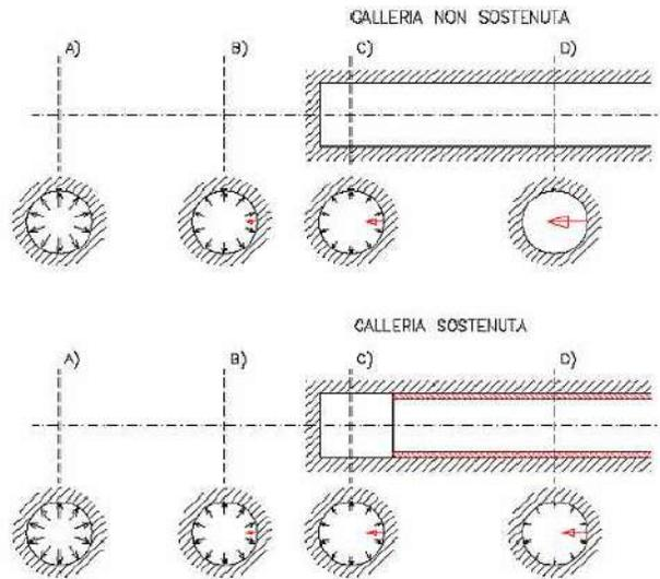
Mediante la sovrapposizione degli effetti delle linee "caratteristiche" della galleria, dei sostegni provvisori e definitivi e del fronte, è possibile ridurre il problema tridimensionale in prossimità del fronte di scavo ad un problema bidimensionale; l'intersezione delle varie curve permette di determinare graficamente il comportamento della galleria allo scavo.
