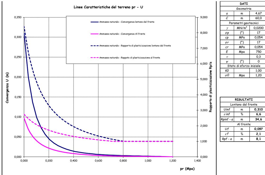
Figura: Linee caratteristiche Bypass carrabile in condizioni naturali \_valori minimi.
