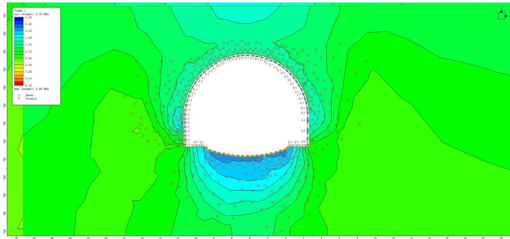
Figura: Fase 5\_Risultati - Sigma 1 + elementi plasticizzati.
