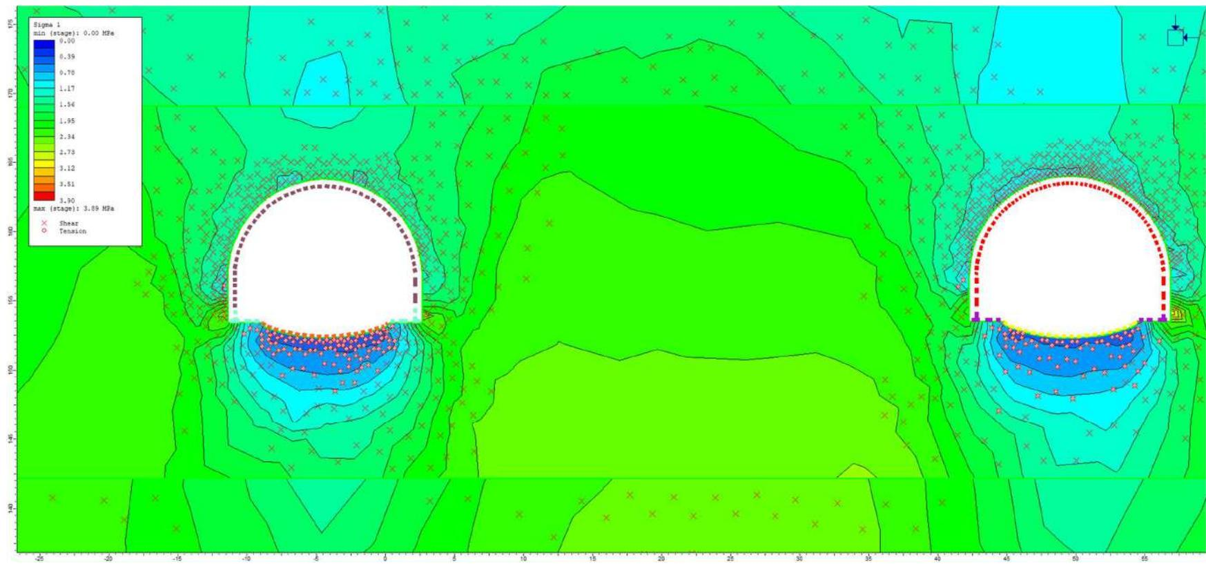
Figura: Fase 15\_Risultati - Sigma 1 + elementi plasticizzati.
