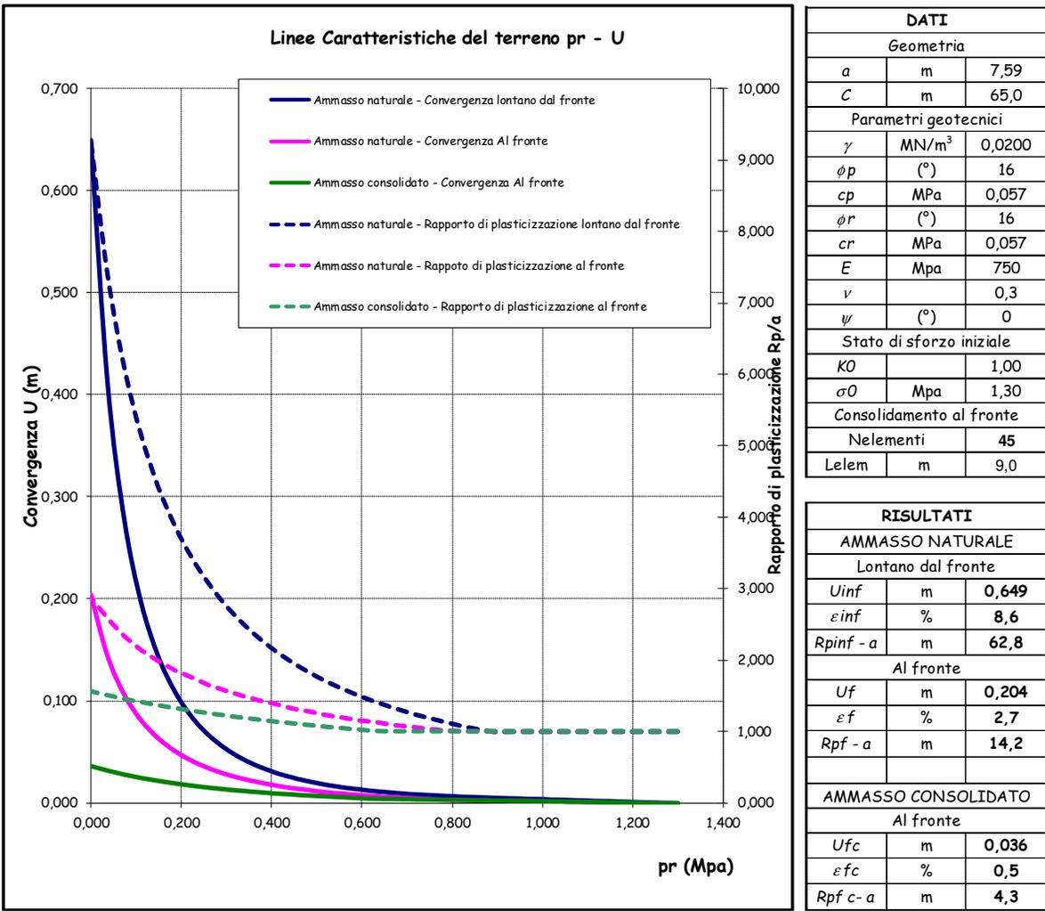
Figura: Linee caratteristiche piazzola di sosta P2 con preconsolidamento del fronte.
