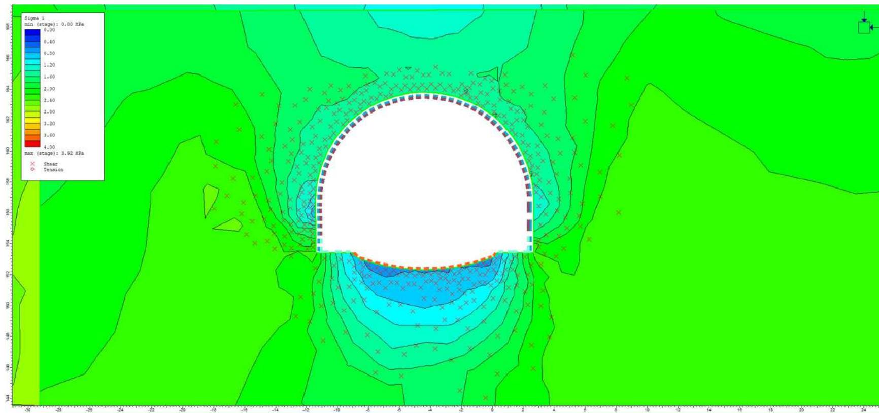
Figura: Fase 8\_Risultati - Sigma 1 + elementi plasticizzati.
