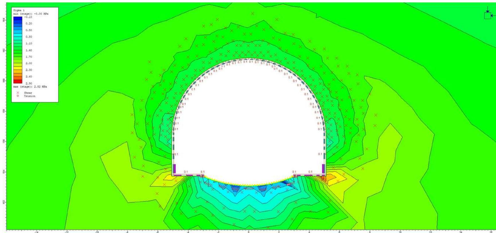
Figura: Fase 11\_Risultati - Sigma 1 + elementi plasticizzati.
