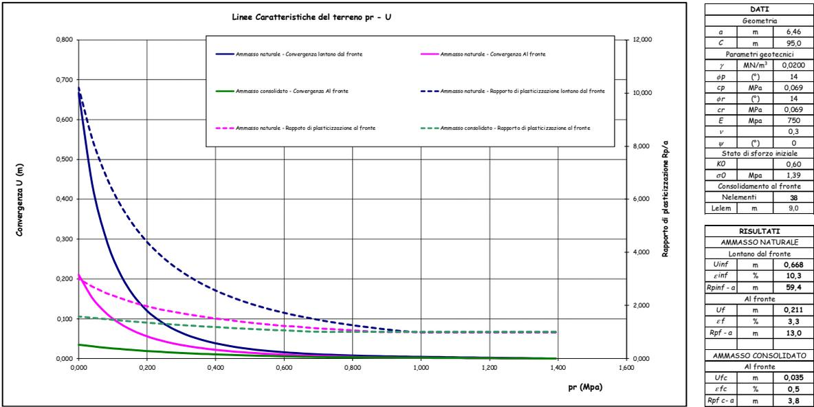
Figura: Linee caratteristiche sagoma 2 a copertura massima=95 m con preconsolidamento del fronte e valori caratteristici minimi.
