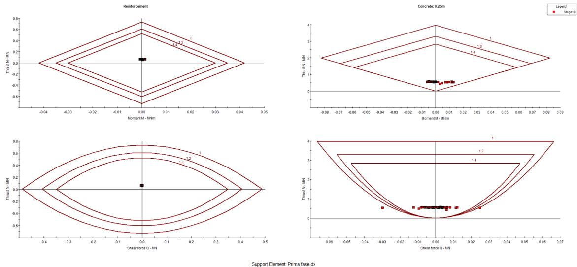
Figura: Dominio di resistenza rivestimento di prima fase.
