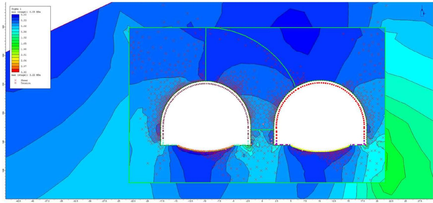
Figura: Fase 14\_Risultati - Sigma 1 + elementi plasticizzati.
