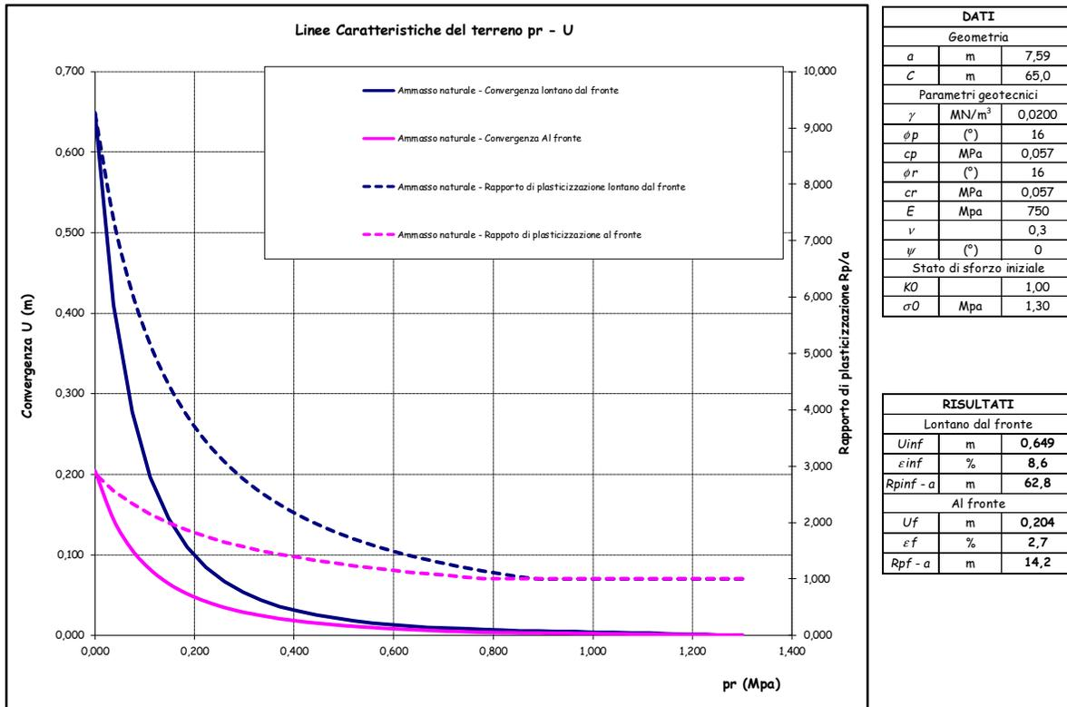
Figura: Linee caratteristiche Piazzola di sosta P2 in condizioni naturali valori minimi.
