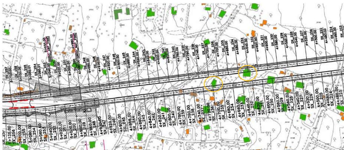
Figura: Interferenze edifici - Galleria Naturale Chighizzu .
