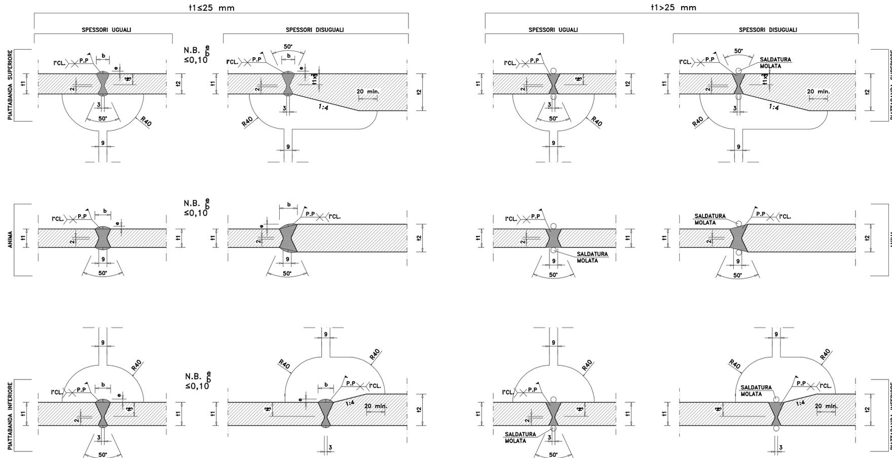
PARTICOLARE ESECUZIONE SALDATURE PIASTRE IMPILATE
