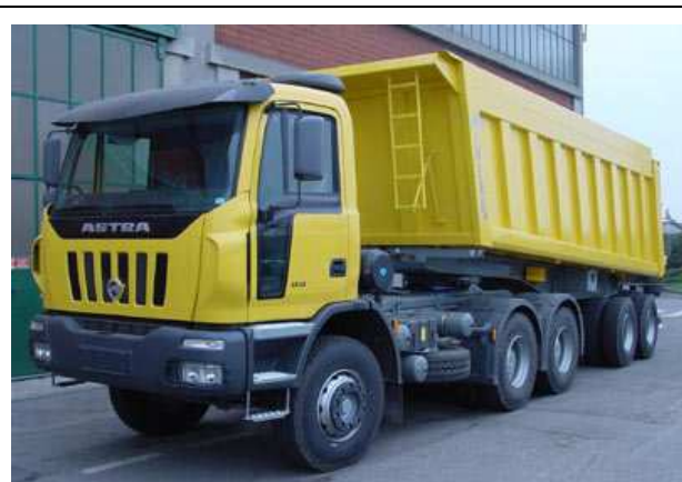
Figura 8 – Veicolo tipo movimenti terra su rete viaria esistente da 20 m 3
