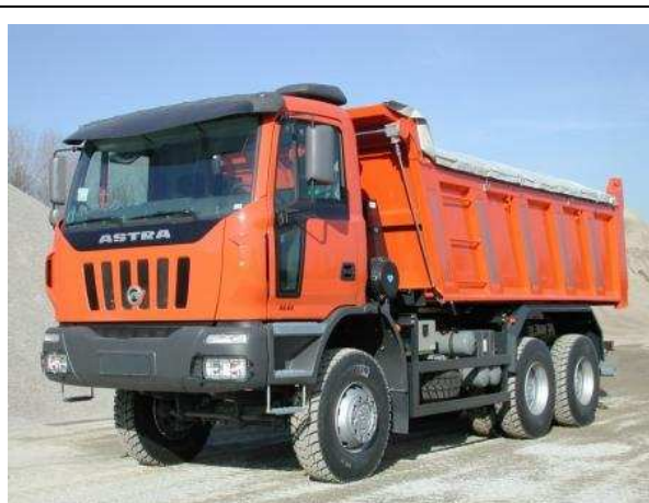
Figura 7 – Veicolo tipo movimenti terra su rete viaria esistente da 12 m 3
