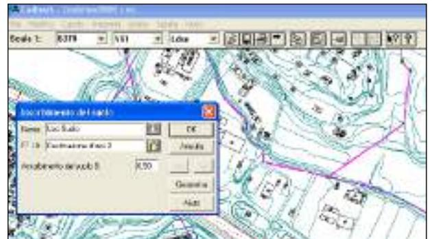
Nella figura si osserva un esempio di poligonatura (colore magenta) con diversi fattori di assorbimento e la finestra di interfaccia grafica mediante la quale è possibile definire il coefficiente per il poligono selezionato.
