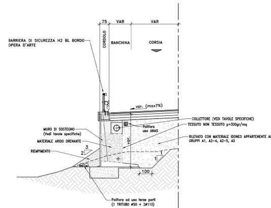
SEZIONE TIPO A (VALIDA PER ASSE PRINCIPALE, RAMPE MONODIREZIONALI E BIDIREZIONALI)
