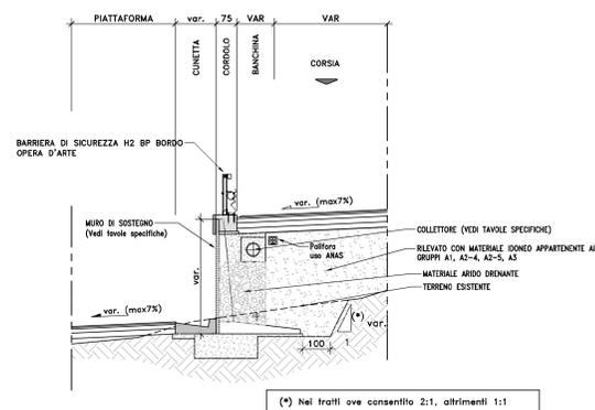
SEZIONE TIPO (VALIDA PER ASSE PRINCIPALE E RAMPE)
