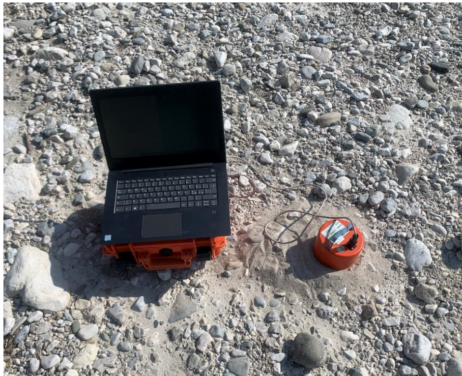
Figura 31 – Stendimento sismico MASW 3 e HVSR 3
