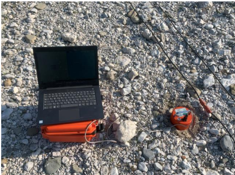
Figura 29 – Stendimento sismico MASW 1 e HVSr 1
