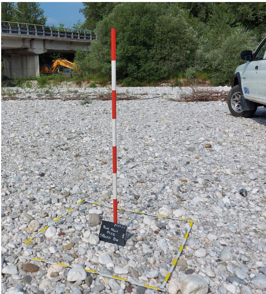
Figura 18 – Stazioni di prelievo campioni alveo – C1
