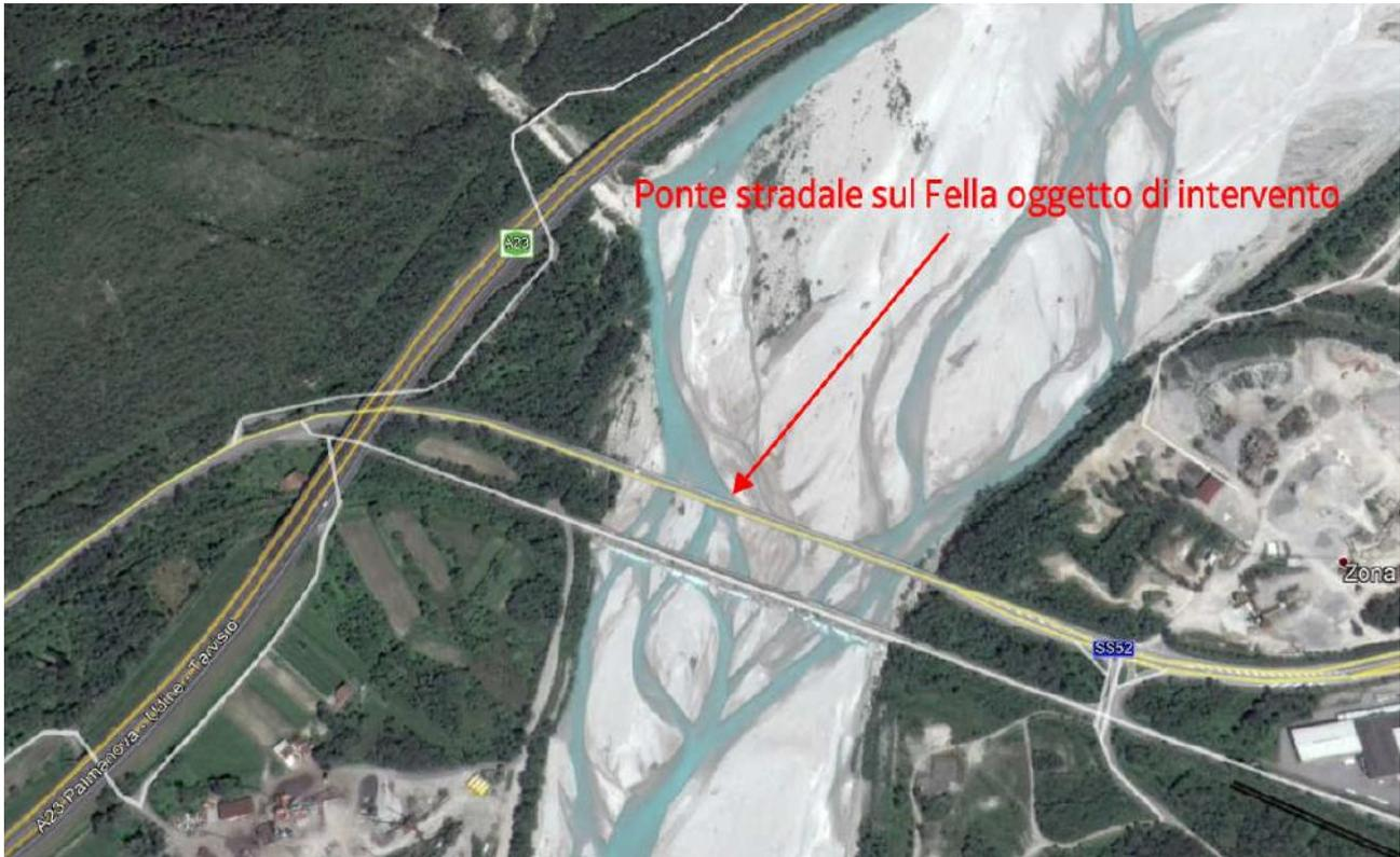
**Fotografia aerea di visione d'insieme dell'area d'intervento con indicato il ponte oggetto dei lavori ed a Sud visibile il ponte ferroviario utilizzato come temporaneo sostituto**
