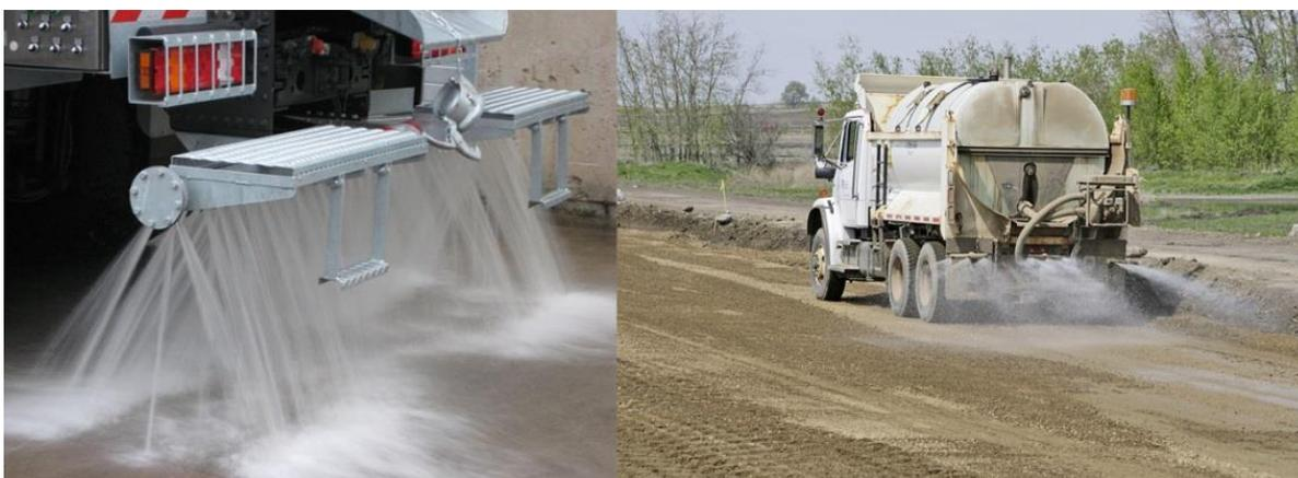
**Figura 3-1: Automezzo per la bagnatura delle piste sterrate**
