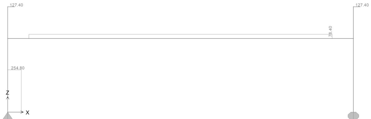
Figura 8.14. Trasverso di appoggio spalla – Sforzo di taglio Ht-vento
