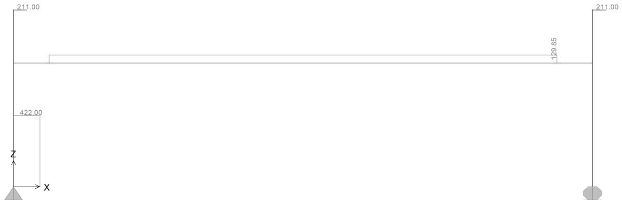
Figura 8.12. Trasverso di appoggio spalla – Sforzo di taglio Ht-SLV
