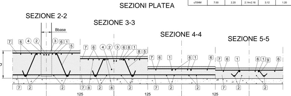
N.B: Il diametro ed il numero dei ferri sono indicati, per ogni altezza (Appellativo), in una riga della tabella delle armature. (Es. u40NM)
