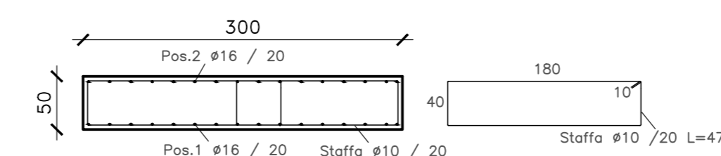
ARMATURA ZATTERA DI FONDAZIONE SEZ. TRANSVERSALE SCALA 1:50
