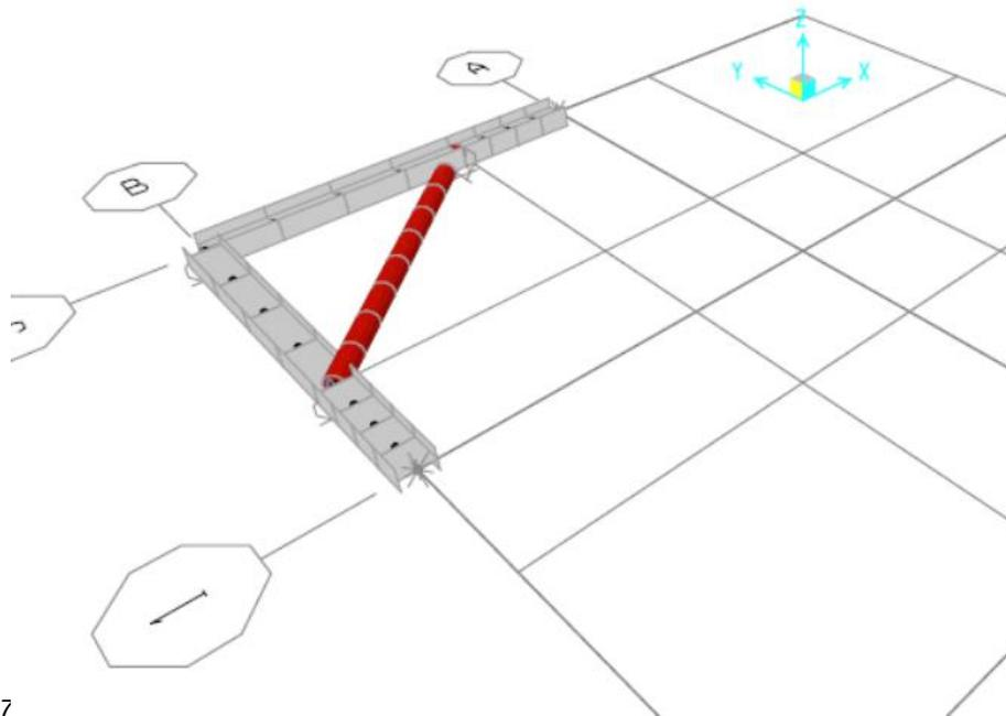
Figura 4 mostra lo schema statico utilizzato in SAP2000.
