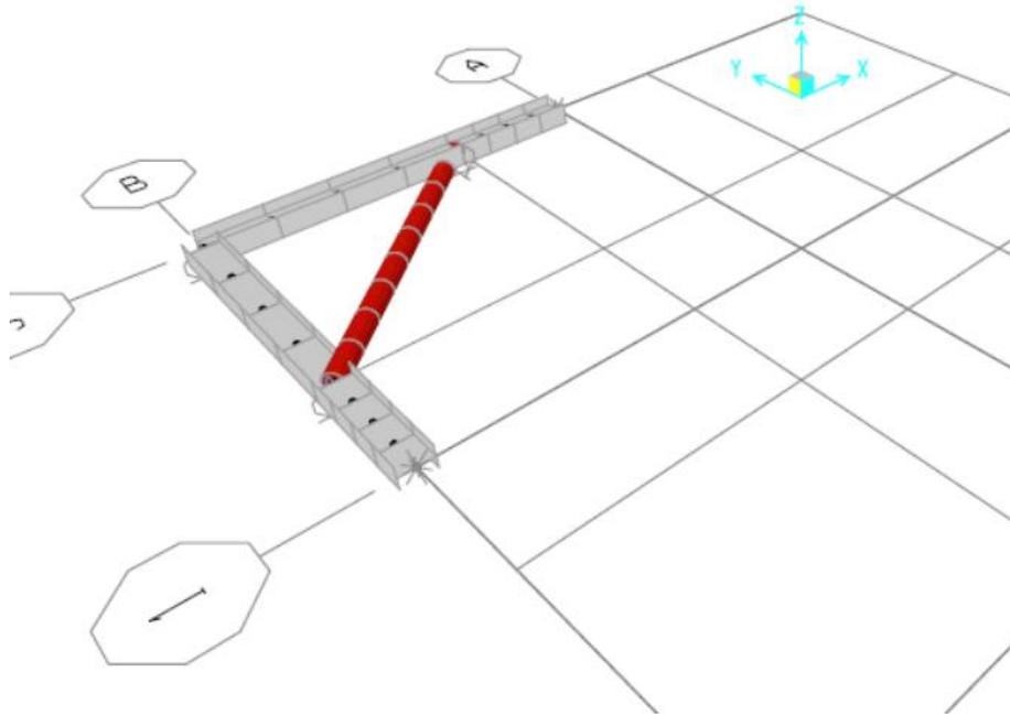
Figura 4: schema statico utilizzato nel codice di calcolo SAP2000 per la valutazione della rigidezza da assegnare al sistema di controventamento
