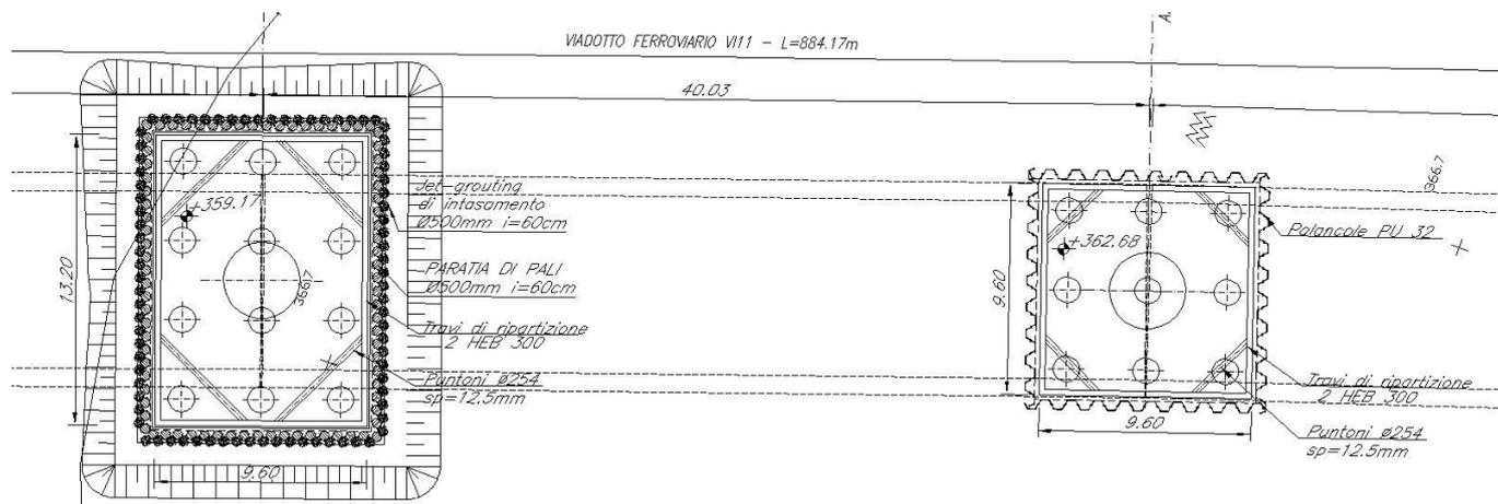
Figura 1: planimetria di scavo tipo con indicazione delle opere di sostegno
