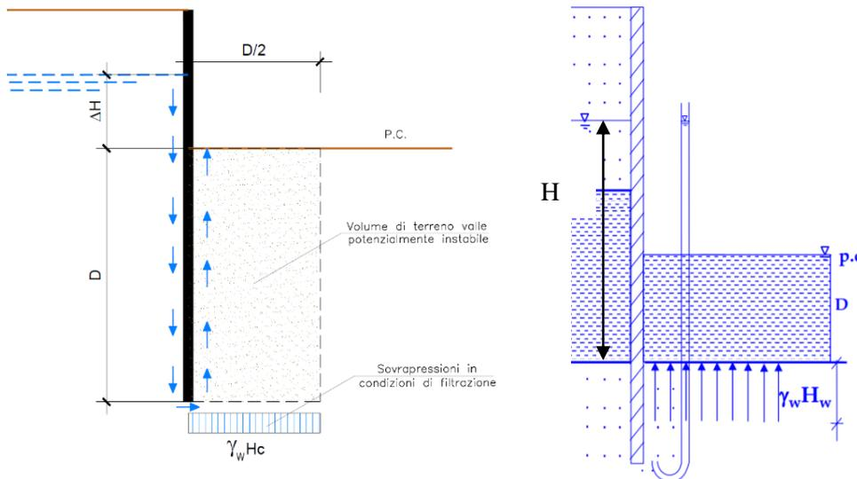
Figura 28: Schema di filtrazione per effetto di scavi sotto falda a valle di opere di sostegno
