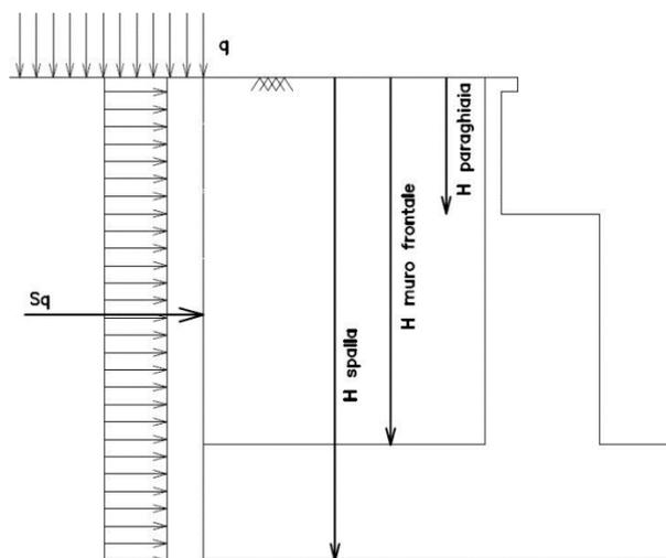
Figura 4-17: Schema per il calcolo degli effetti della spinta dovuta al sovraccarico accidentale
