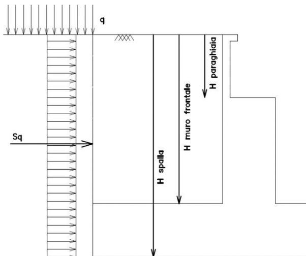
Figura 4-15: Schema per il calcolo degli effetti della spinta dovuta al sovraccarico accidentale
