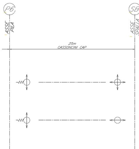
Figura 1-1-1: schema appoggi
