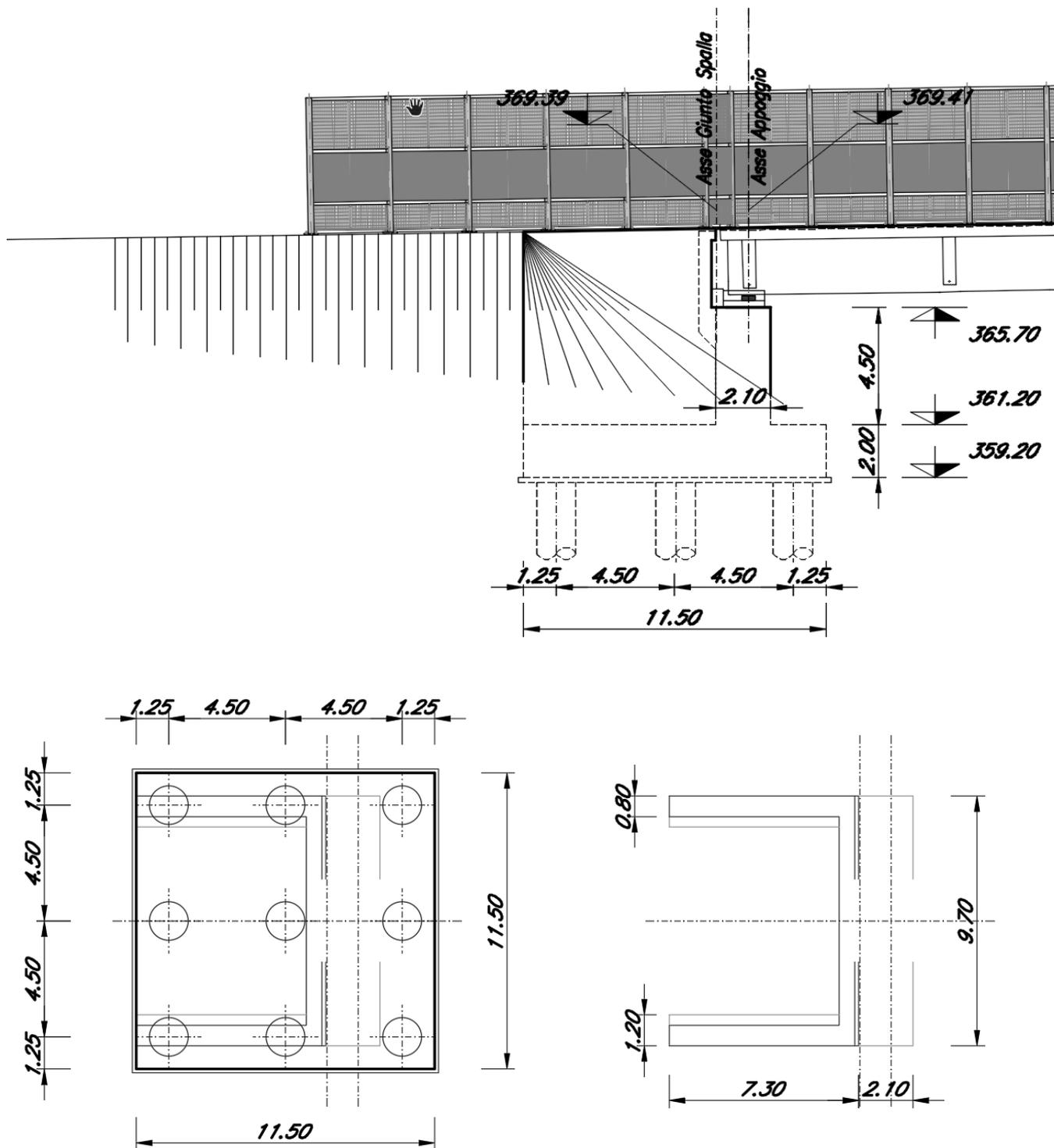
Figura 1-4 - elaborati grafici spalla A (mobile)
