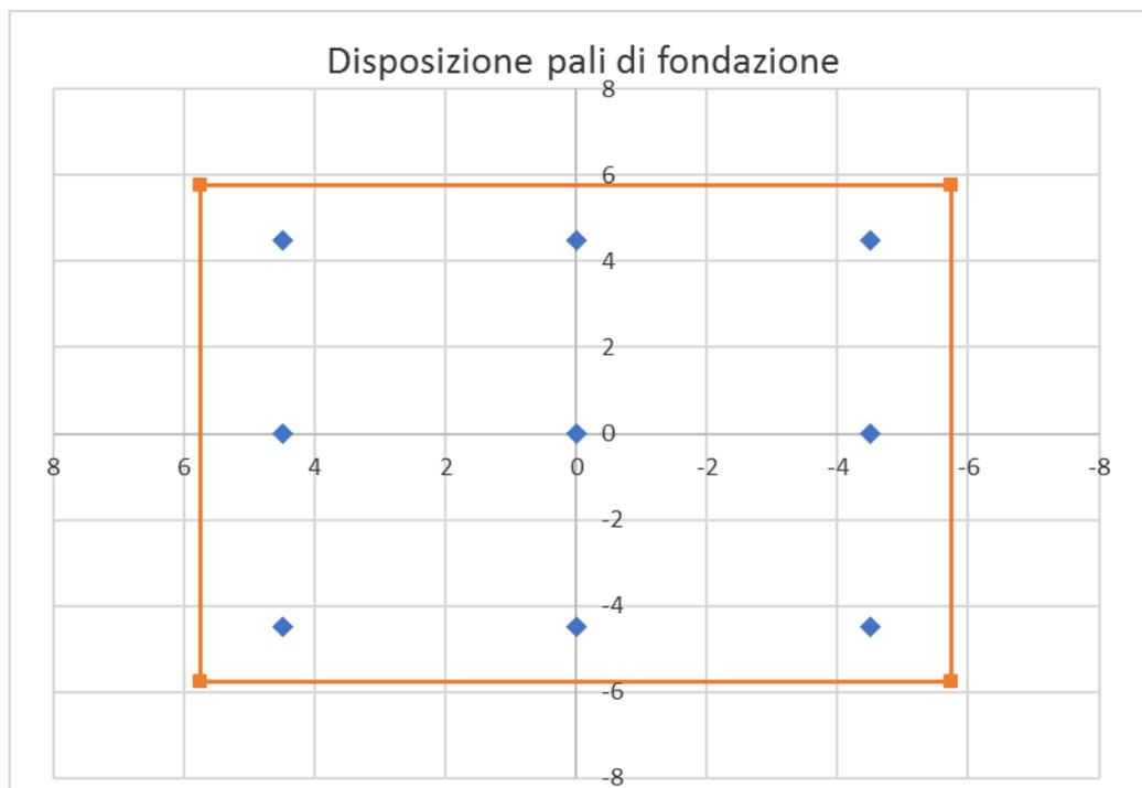
**Figura 4-29 - disposizione dei pali di fondazione**
