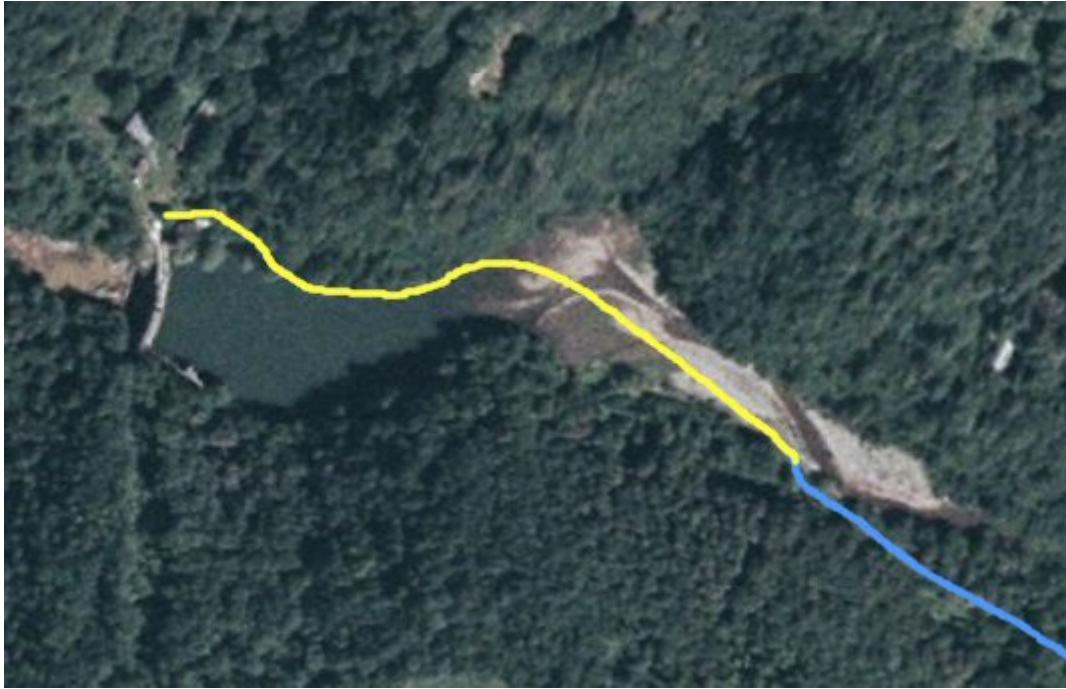
Fig. 11 La pista provvisoria di accesso al cantiere: in azzurro la pista esistente – in giallo il guado e la pista in alveo
