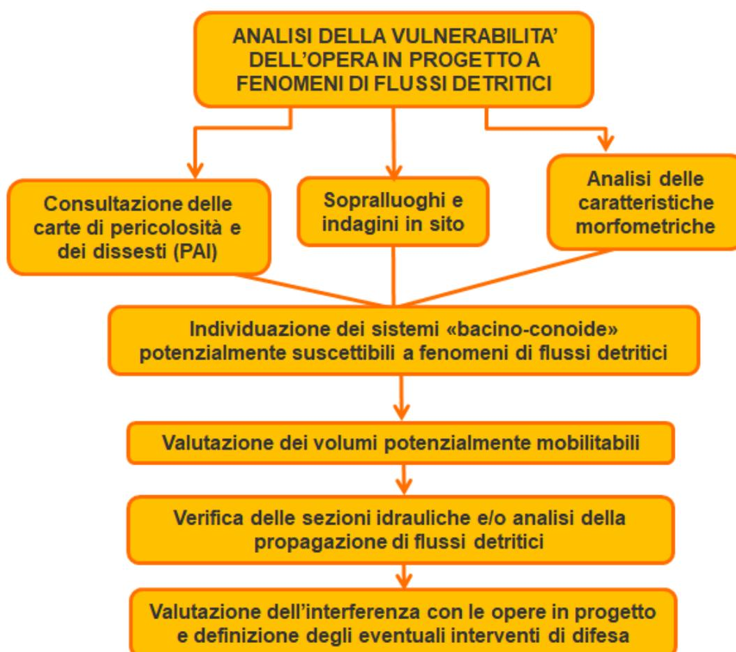
Figura 2 - Vulnerabilità a fenomeni di flussi detritici - Flow chart.
