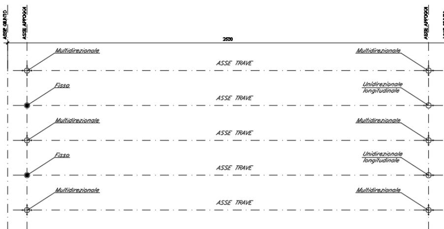
Figura 3 – Schema degli apparecchi di appoggio
