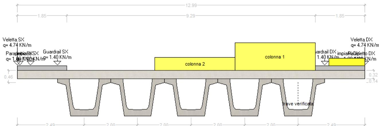
Figura 12 - Disposizione per calcolo trave di bordo
