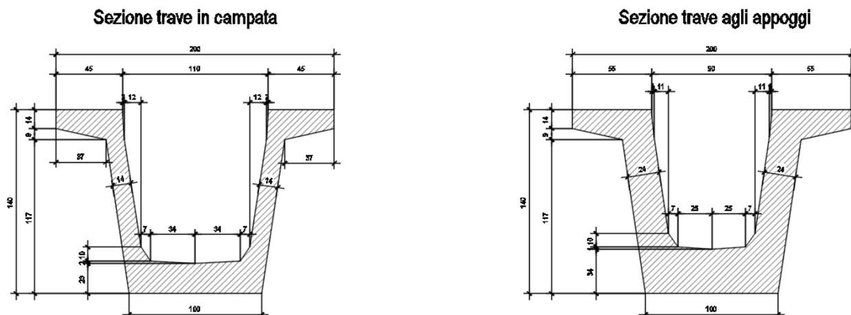
Figura 2 – Sezione della trave in c.a.p.
