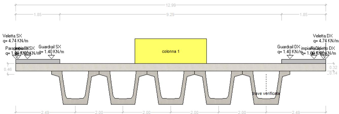
Figura 13 - Disposizione per calcolo M max su trasverso
