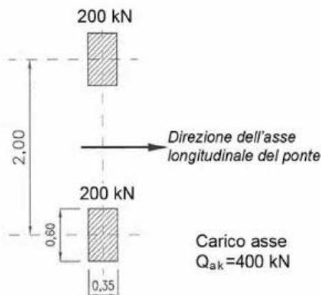
Figura 7: Schema di carico 2 per verifiche locali
