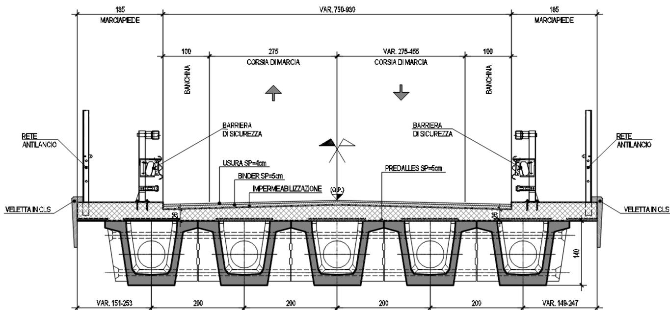
Figura 1 – Sezione tipica trasversale dell'impalcato
