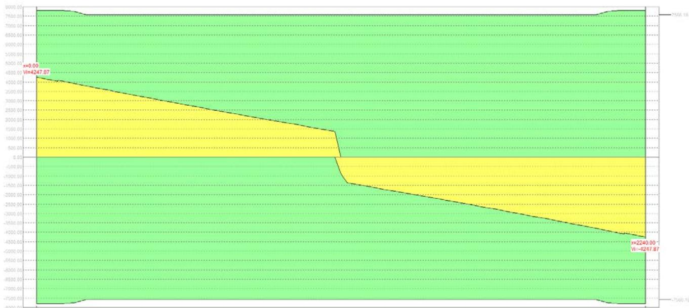
Figura 17 - Scorrimento interfaccia trave-soletta
