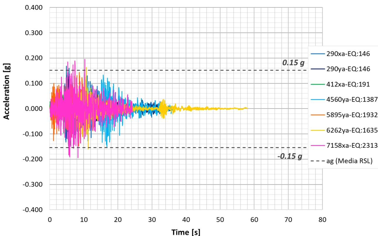
Figura 18 – Risposta Sismica Locale per SLV di L3B – IV03 (NV63c):Accelerogrammi a 4,0 m di profondità
