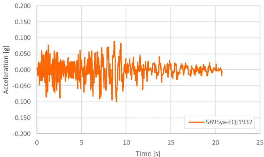
Figura 12 – Accelerogramma naturale: Waveform 5895ya – Eartquake 1932
