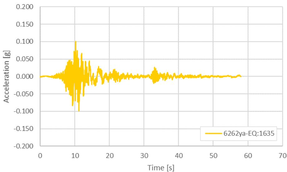
Figura 13 – Accelerogramma naturale: Waveform 6262ya – Eartquake 1635
