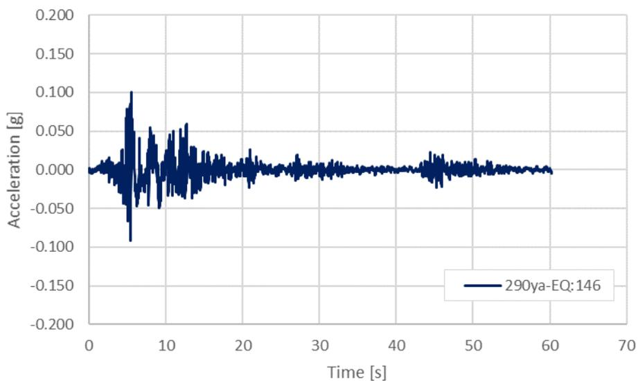
Figura 9 – Accelerogramma naturale: Waveform 290ya – Eartquake 146
