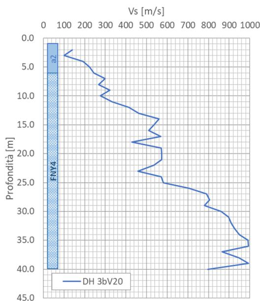
Figura 2 – Prova sismica in foro eseguita per il viadotto IV03 (NV62c), con relativa stratigrafia: DH 3BV20 ( $V_{s,q} = 336$  m/s - Suolo tipo E)
