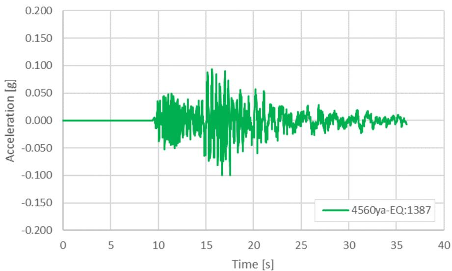
Figura 11 – Accelerogramma naturale: Waveform 4560ya – Eartquake 1387
