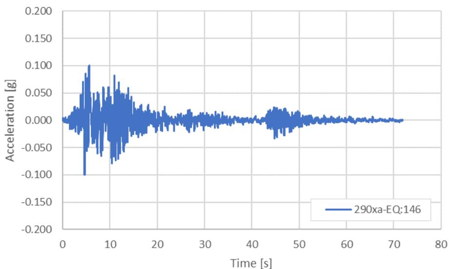
Figura 8 – Accelerogramma naturale: Waveform 290xa – Eartquake 146
