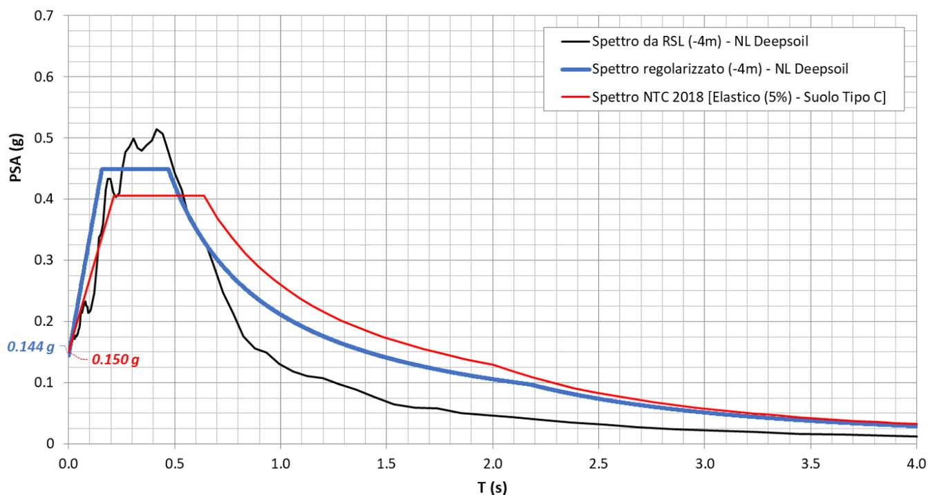
Figura 19 – Risposta Sismica Locale per SLV di L3B – IV03 (NV63c): confronto tra spettro di RSL e spettro di normativa
