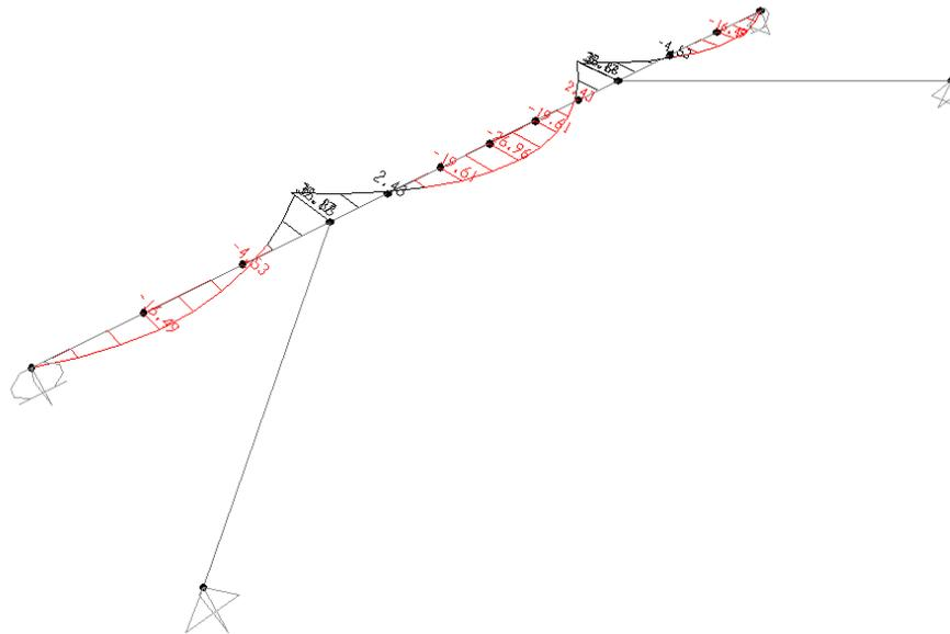
Le verifiche delle sezioni vengono svolte direttamente dal software di calcolo; il coefficiente massimo di sfruttamento è pari ad 0.11:
