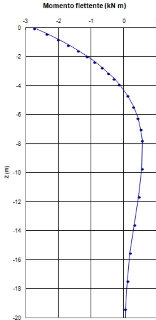
Per le palificate in presenza di scalzamento, il valore del parametro  $\alpha_m$  (=  $M_o/T_o$  a testa palo), è stato valutato considerando non reagente il terreno sino alla profondità di scalzamento. Il valore del parametro indicato per lo scalzamento va associato alle sole condizioni di carico statiche con scalzamento, per tutte le altre combinazioni (SLU statica, SLV sismica e SLE) va associato il valore del parametro indicato per i pali in assenza di scalzamento.
