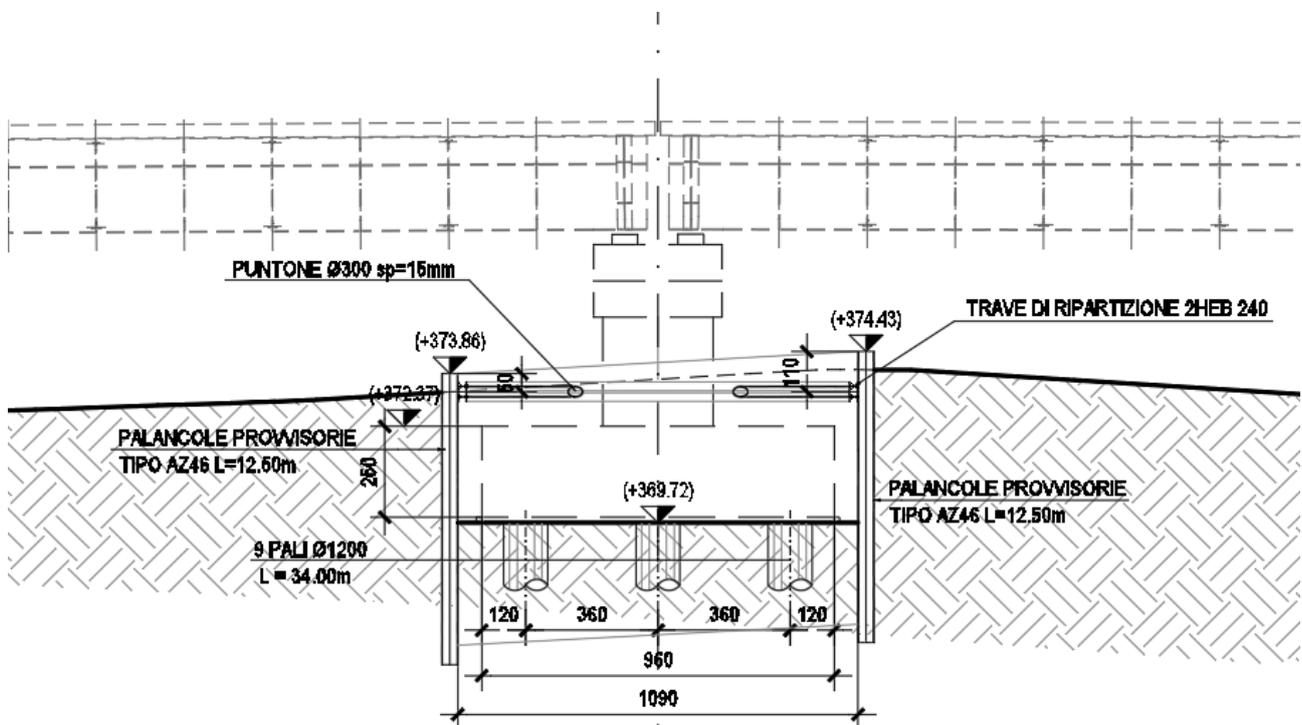
Fig. 1 – Sezione trasversale dell'opera
