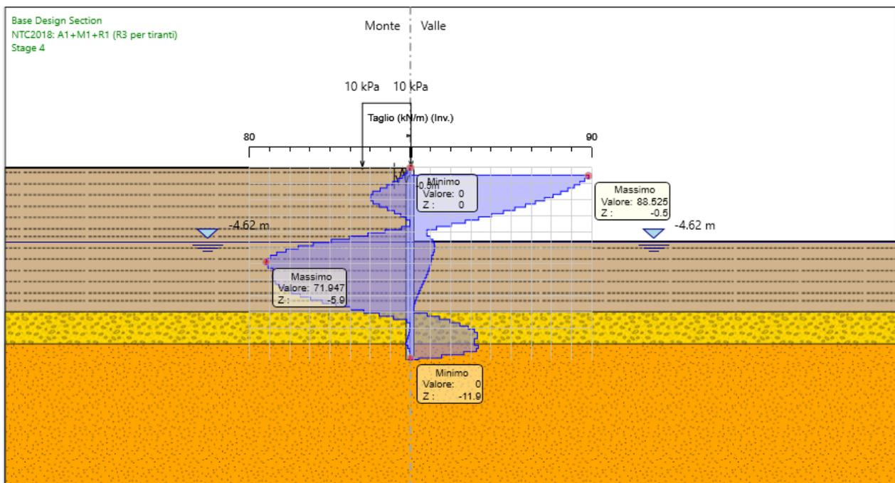
Nel seguito si riportano i risultati delle verifiche strutturali delle palancole metalliche a flessione e a taglio condotte mediante l'ausilio di Paratie plus. In particolare si riportano i diagrammi dei tassi di sfruttamento sulle palancole, ottenuti come rapporto tra sollecitazione presente e resistenza disponibile in ogni sezione delle palancole.
