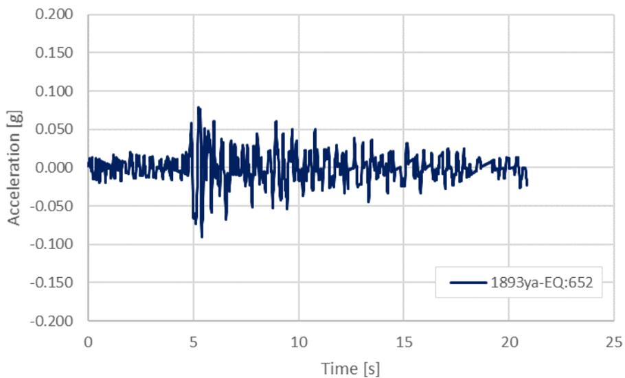
Figura 9 – Accelerogramma naturale: Waveform 1893ya – Eartquake 652
