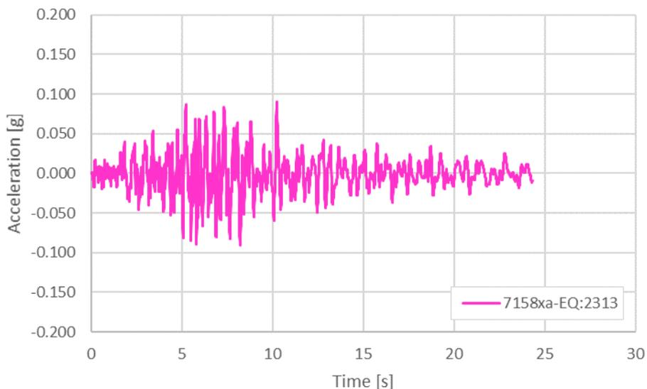
Figura 14 – Accelerogramma naturale: Waveform 7158xa – Eartquake 2313
