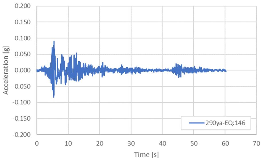
Figura 8 – Accelerogramma naturale: Waveform 290ya – Eartquake 146
