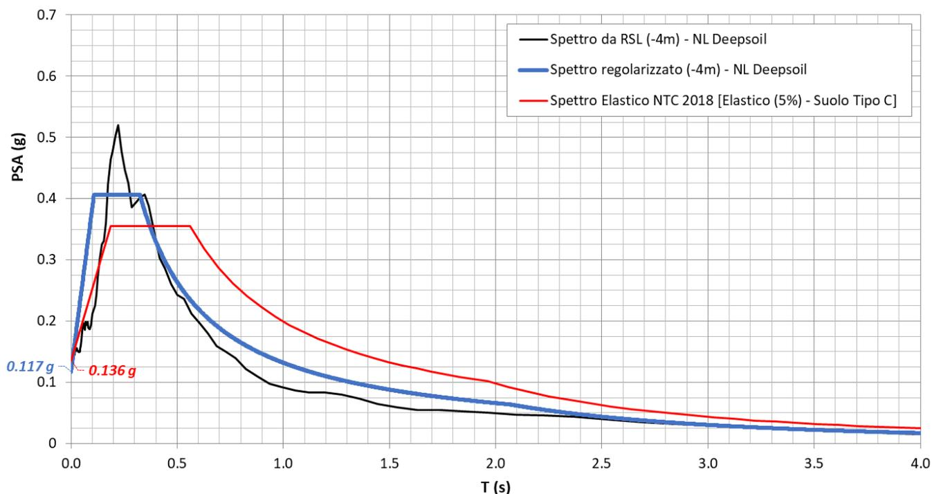
Figura 19 – Risposta Sismica Locale per SLV di L3B – NW05 (NV56a): confronto tra spettro di RSL e spettro di normativa
