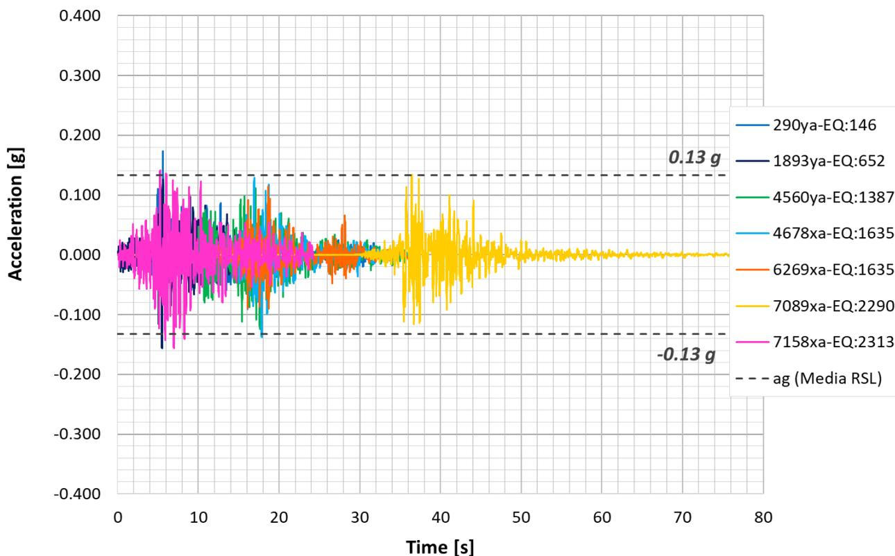
Figura 18 – Risposta Sismica Locale per SLV di L3B – NW05 (NV56a):Accelerogrammi a 4,0 m di profondità
