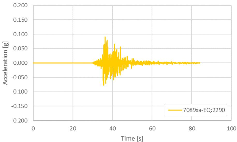
Figura 13 – Accelerogramma naturale: Waveform 7089xa – Eartquake 2290
