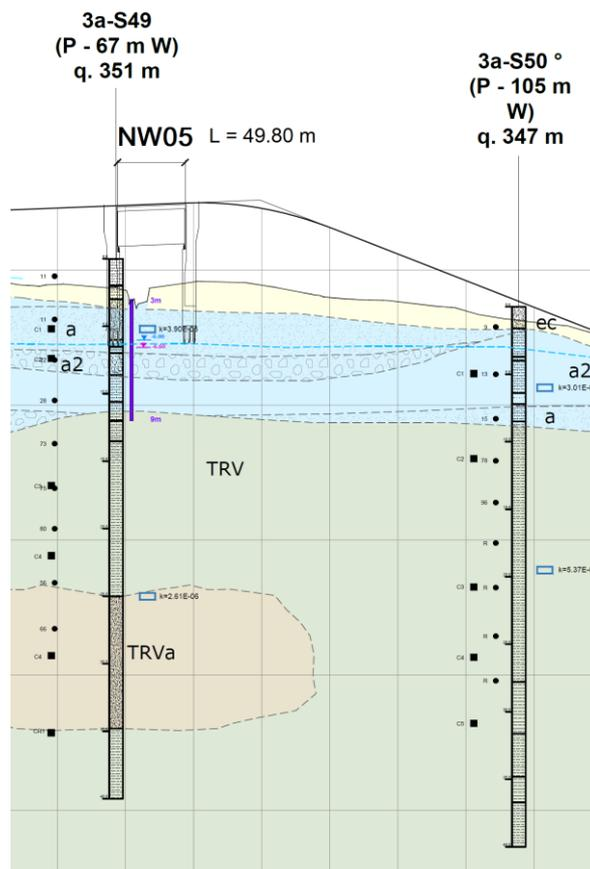
Figura 1: Profilo stratigrafico relativo al viadotto NW05 (NV56a)
