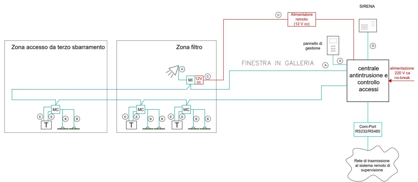
**INSTALLAZIONE TIPO COMPONENTI IMPIANTO ANTINTRUSIONE**
