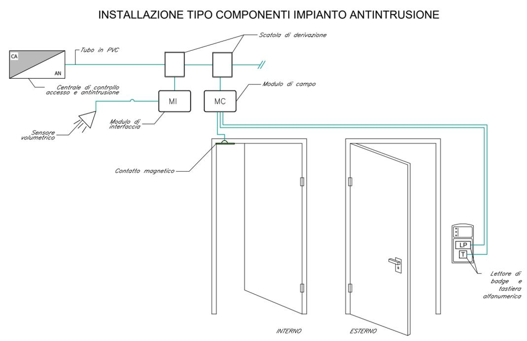
INSTALLAZIONE TIPO COMPONENTI IMPIANTO ANTINTRUSIONE
