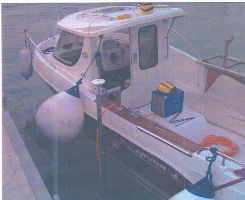
Figura 6: Foto dell'imbarcazione ARVOR 215 utilizzata per i rilievi MBES.
