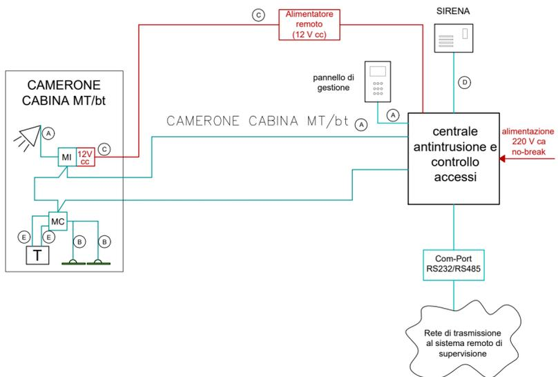
INSTALLAZIONE TIPO COMPONENTI IMPIANTO ANTINTRUSIONE
