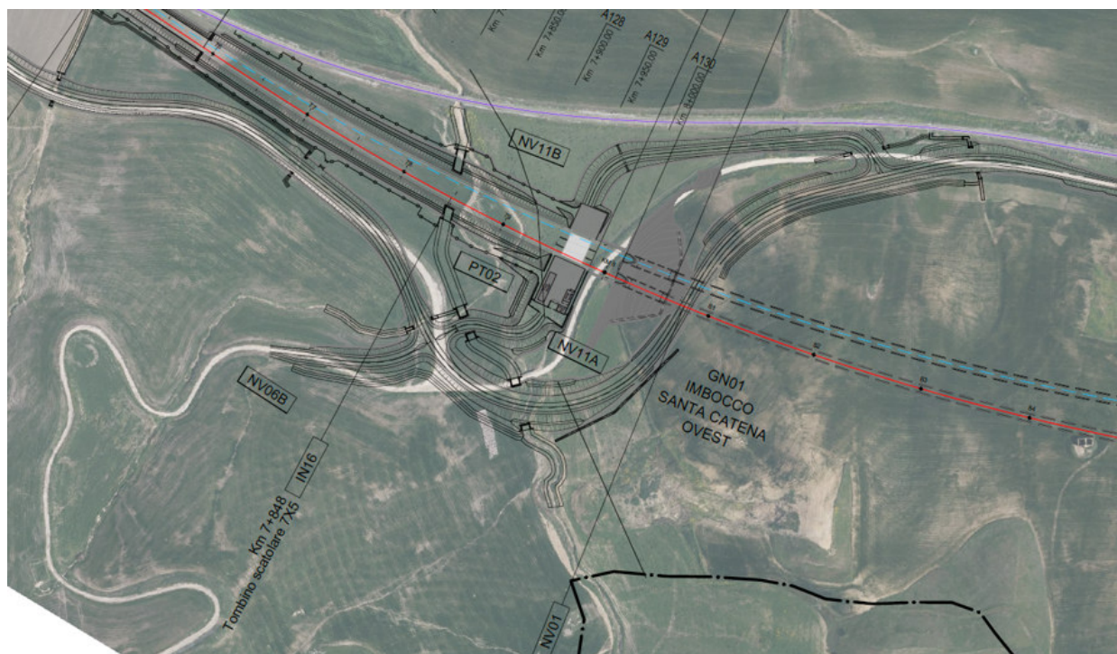
Figura 72 – Ortofoto dell'imbocco della galleria Santa Catena lato Palermo
