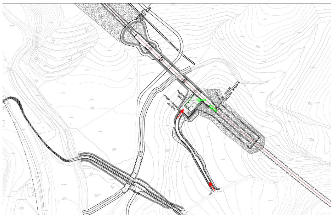
Figura 83 – Area di sicurezza imbocco lato Palermo della galleria Trabona
