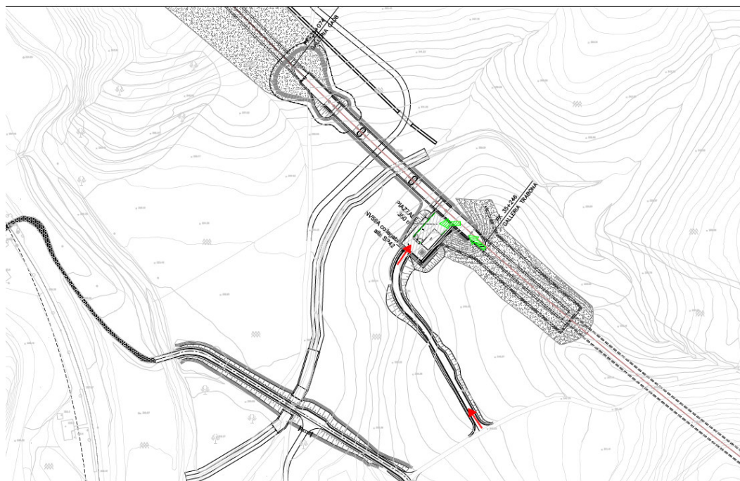
Figura 52 – Area di sicurezza imbocco lato Palermo della galleria Trabona
