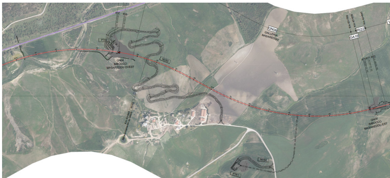
Figura 91 – Aree di sicurezza all'imbocco della galleria Masareddu lato Palermo e all'imbocco della finestra Masareddu.
