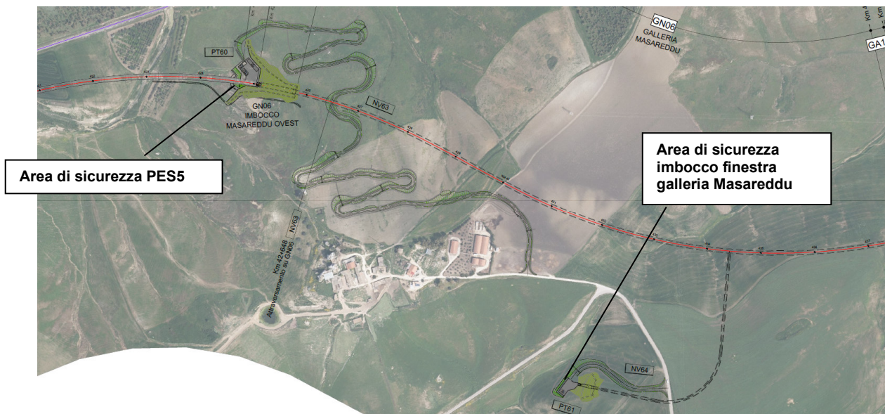
Figura 56 – Area di sicurezza imbocco finestra galleria Masareddu, collegata con imbocco lato Palermo galleria Masareddu
