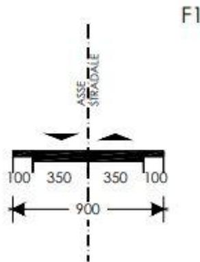
**Figura 2: Sezione tipo di progetto, Tipo F1**
