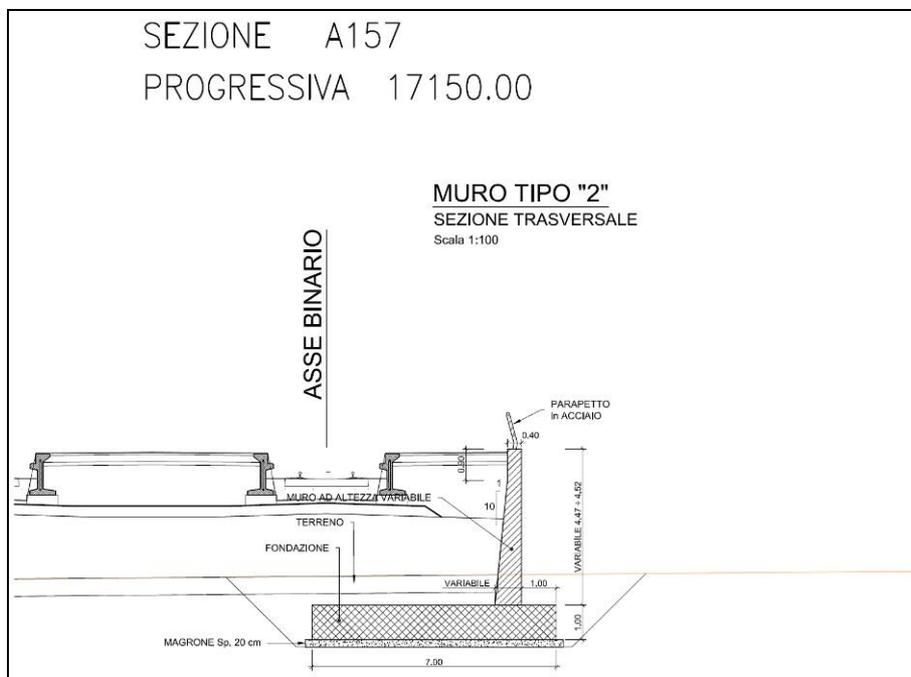
Figura 1-4 – RI06: Muro di sostegno in dx MU11 – Sezione trasversale muro tipo 2.
