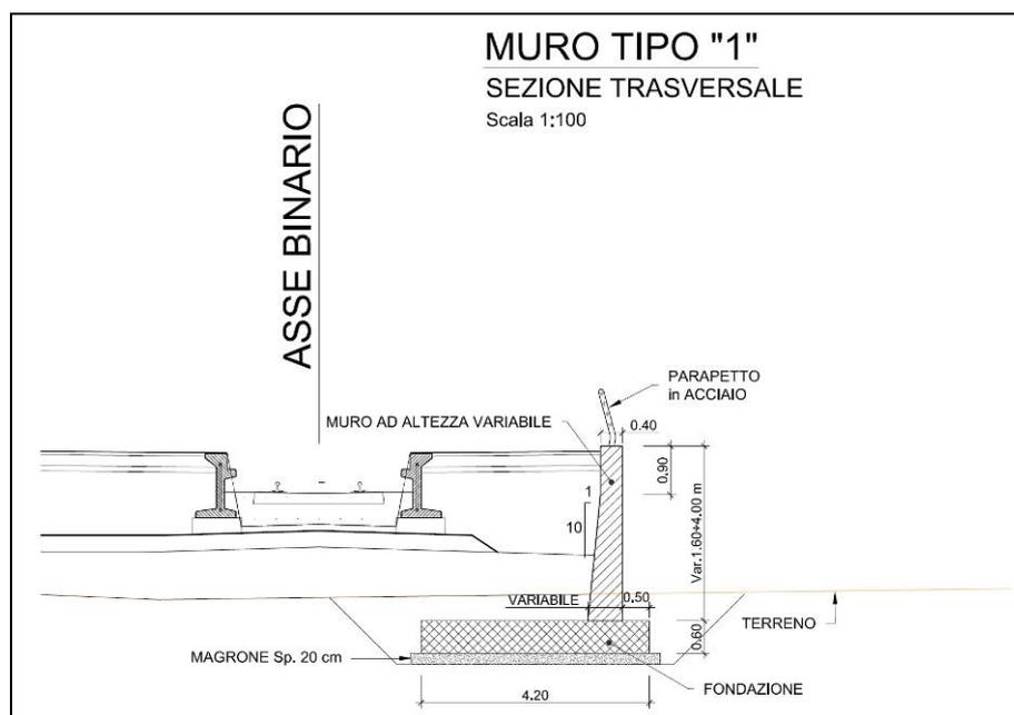
Figura 1-3 – RI06: Muro di sostegno in dx MU11 – Sezione trasversale muro tipo 1.
