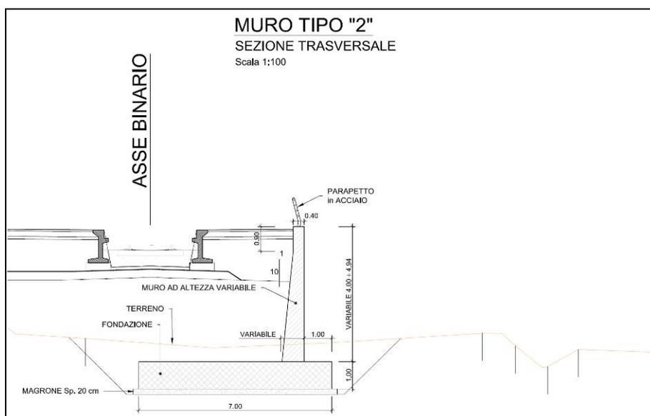
Figura 1-6 – RI06: Muro di sostegno in dx MU12 – Sezione trasversale muro tipo 2.
