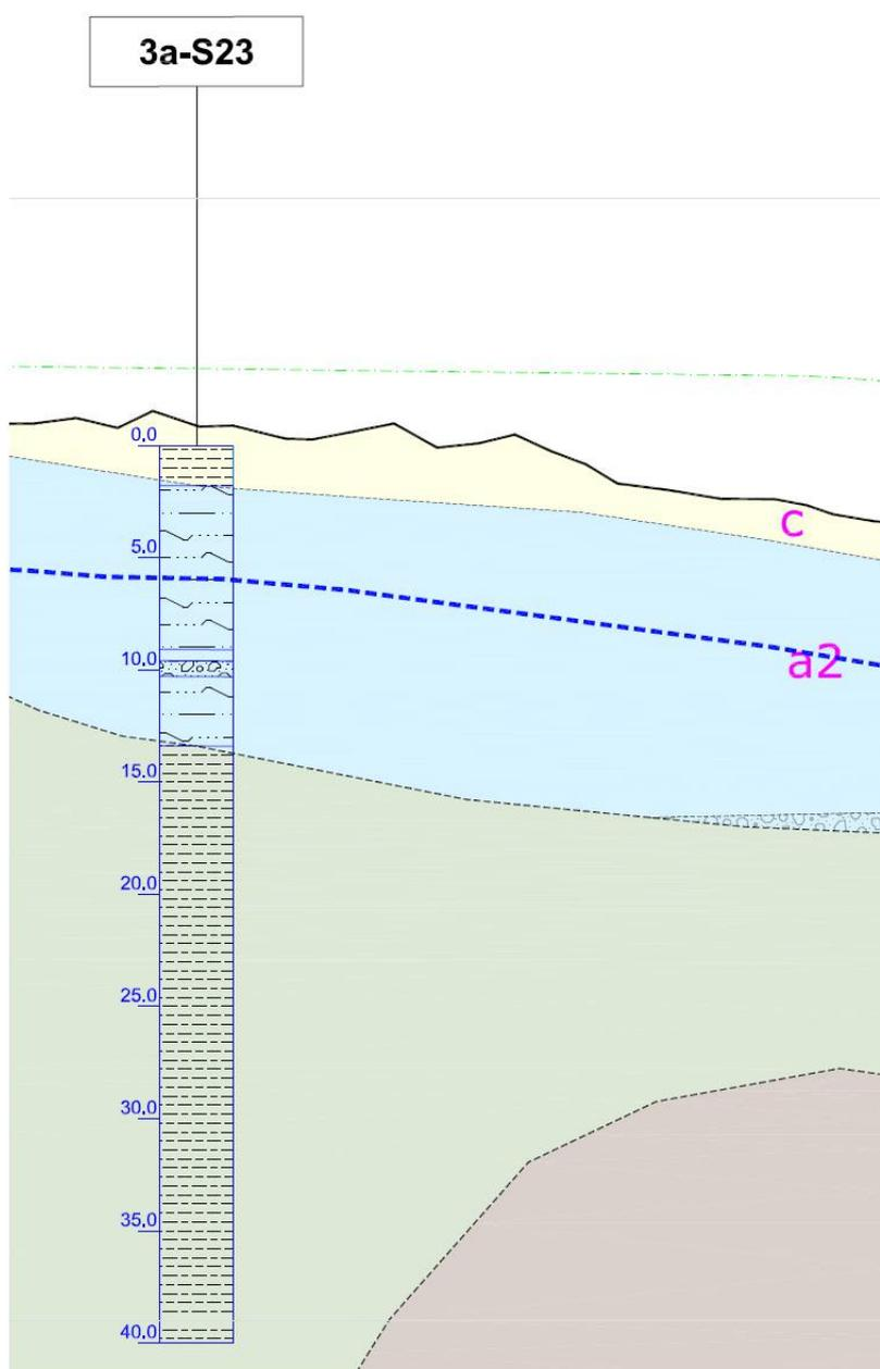
Figura 6-1 – Stralcio del profilo geotecnico.
