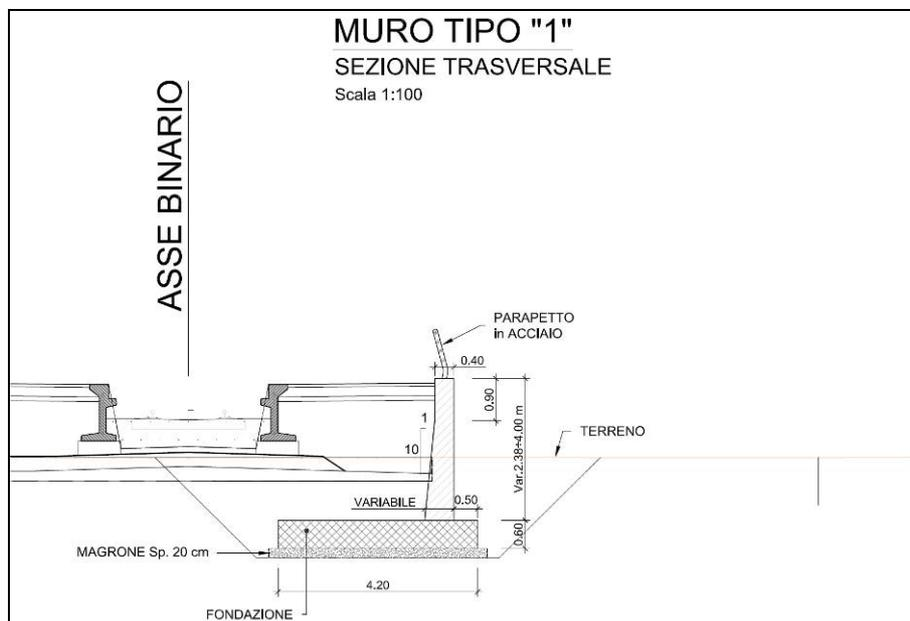
Figura 1-5 – RI06: Muro di sostegno in dx MU12 – Sezione trasversale muro tipo 1.
