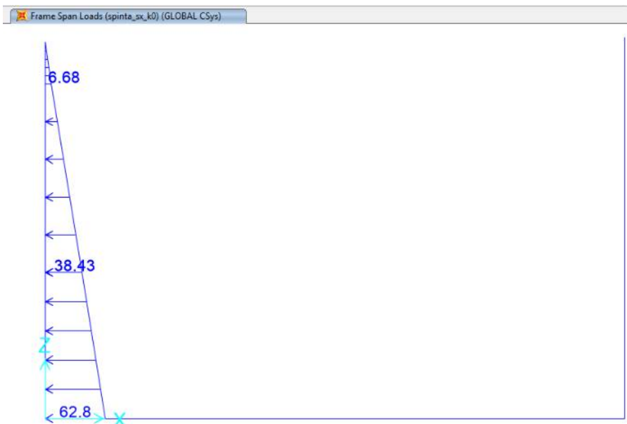
Figura 10-5 – Spinta del terreno sul piedritto sinistro.
