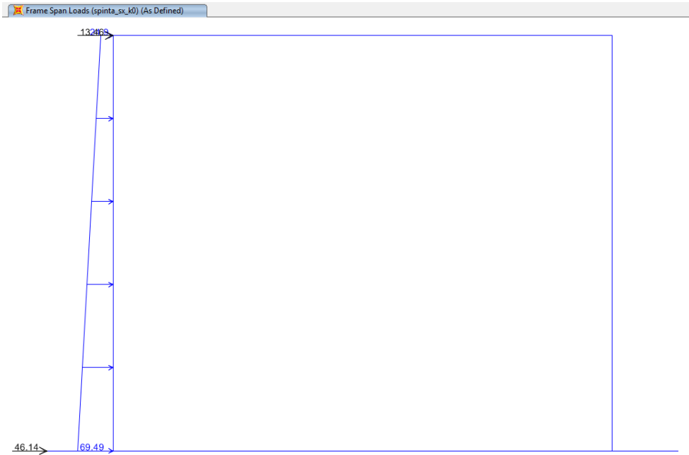
Figura 8 – Spinta del terreno sul piedritto sinistro.
