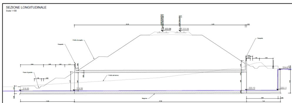
Figura 1b. Sezione longitudinale dello scatolare
