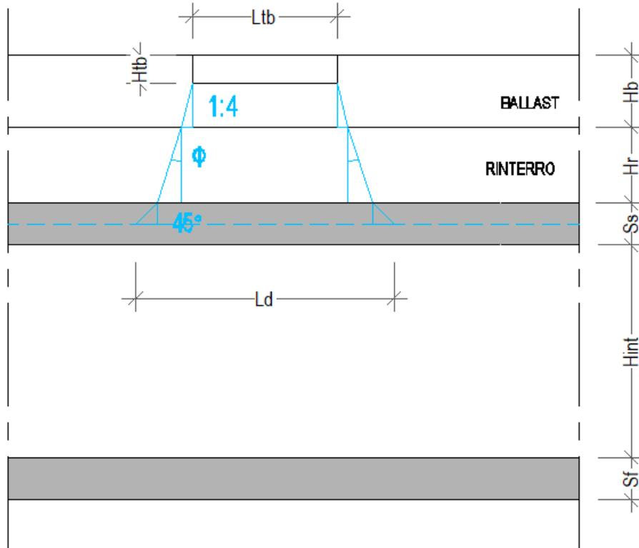
Figura 7. Schema modalità di diffusione dei carichi ferroviari
