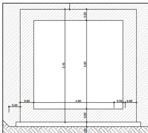
Figura 1c. Sezione trasversale dello scatolare
