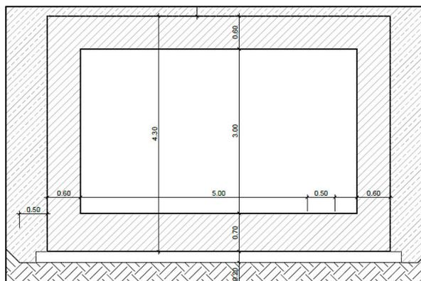
Figura 1c. Sezione trasversale dello scatolare
