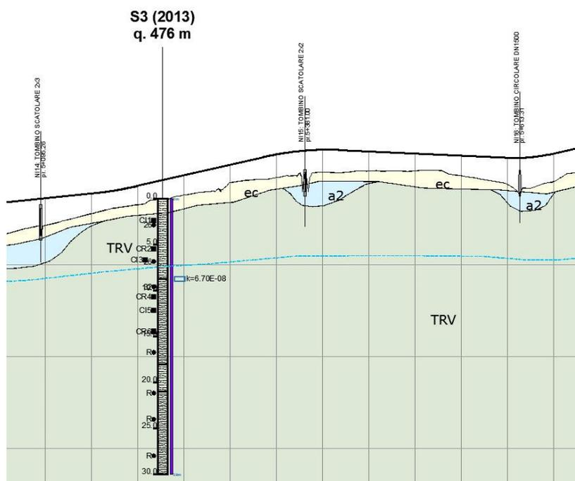
Per l'inquadramento geotecnico si fa riferimento alla relazione geotecnica, della quale si riportano gli stralci significativi del profilo geotecnico e dei parametri geotecnici del terreno di fondazione, del rinterro e del rinfianco.
