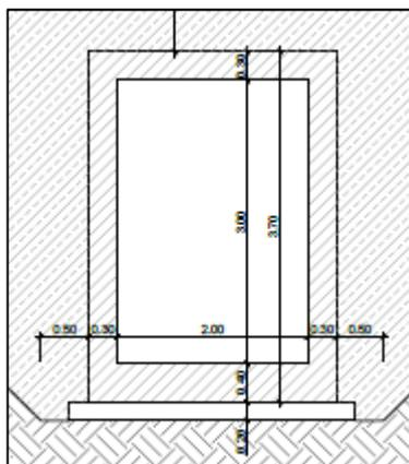
Figura 1c. Sezione trasversale dello scatolare
