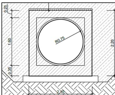
Figura 1c. Sezione trasversale dello scatolare
