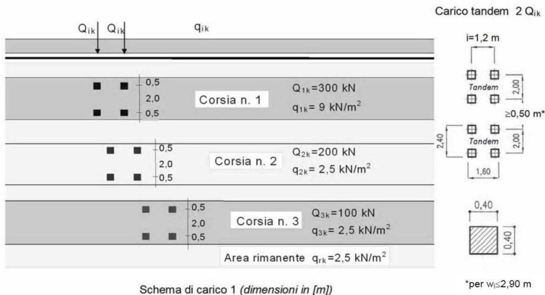
Figura 20 – Schema di Carico 1 del D.M. 17/01/2018
