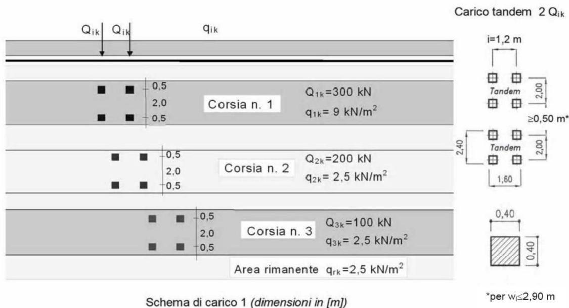
Figura 7 – Schema di Carico 1 del D.M. 17/01/2018
