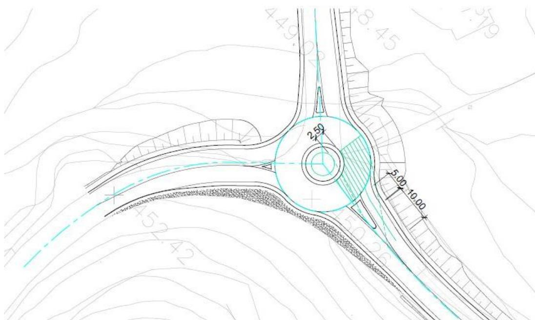
Figure 8-2: Triangoli visibilità intersezione NV08B con NV08
