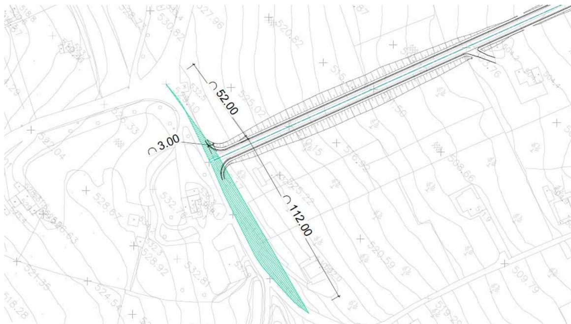
Figure 11-1: Triangoli visibilità intersezione a pr. 0+000,00 NV12A
