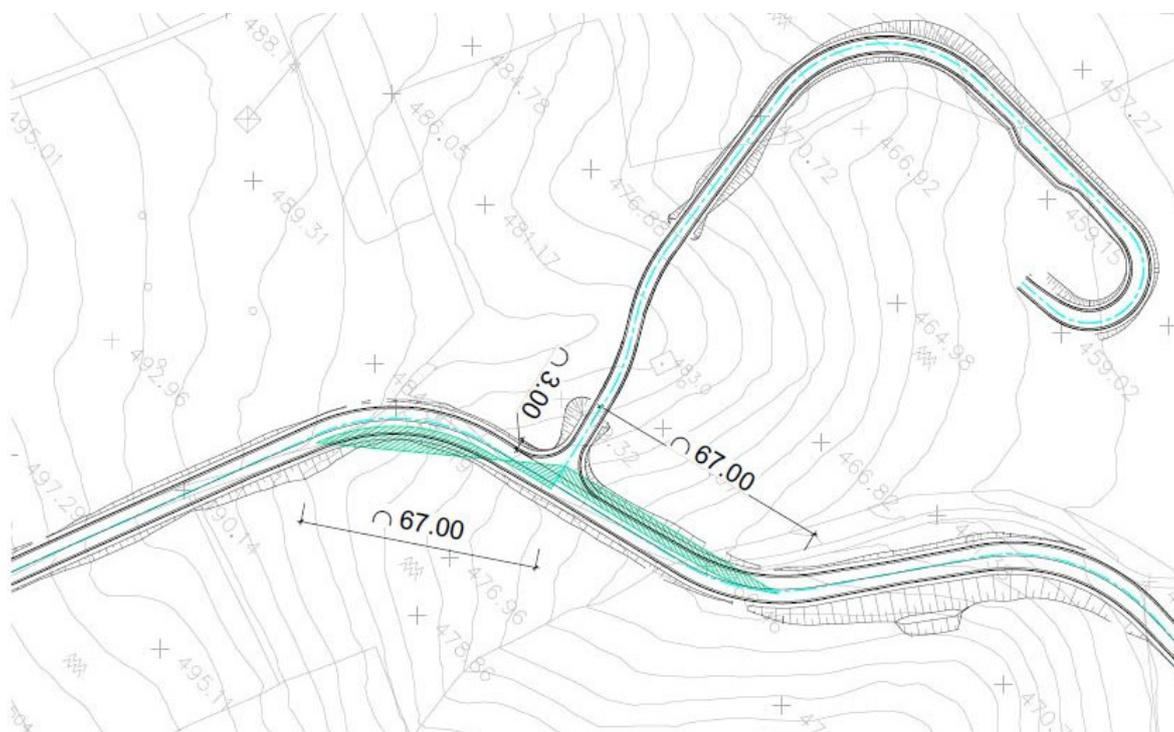
Figure 11-2: Triangoli visibilità intersezione a pr. 0+377,61,00 NV12A
