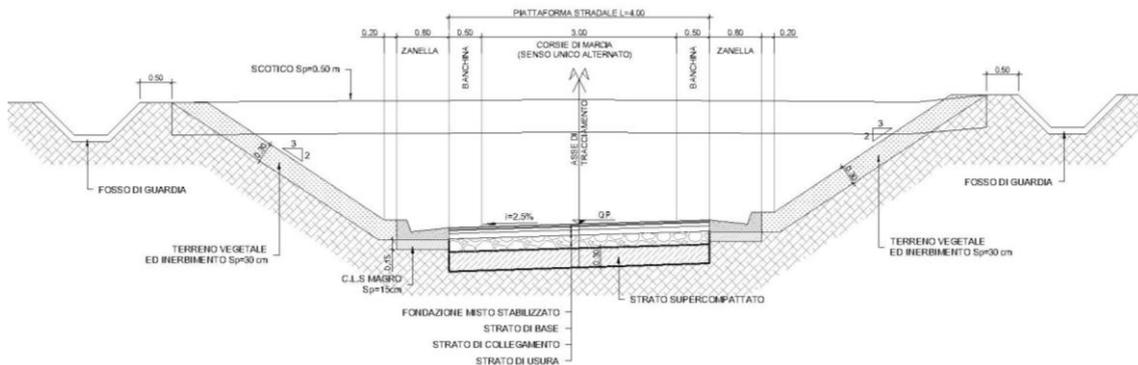
Figure 6-4: sezione tipo strada 4m in trincea
