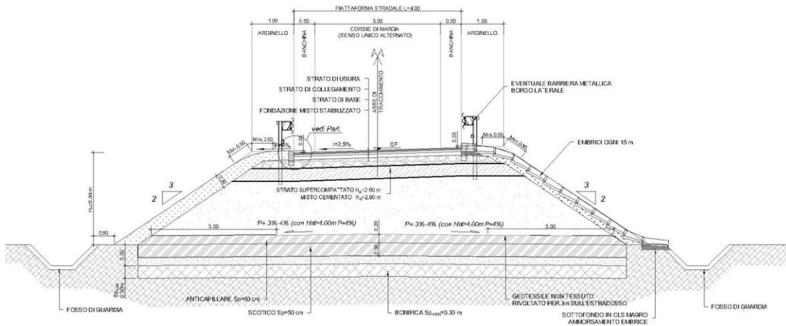
Figure 6-2: sezione tipo strada 4m in rilevato  $H_{rl1} \leq 6.00$  m
