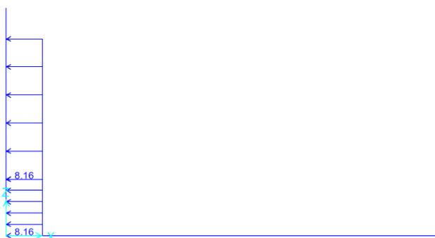
Figura 14 – Spinta del treno di carico LM71 in sinistra.
