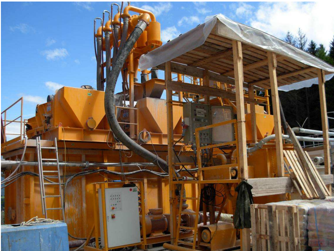
Fig. 2.6 - Sistema di disidratazione
