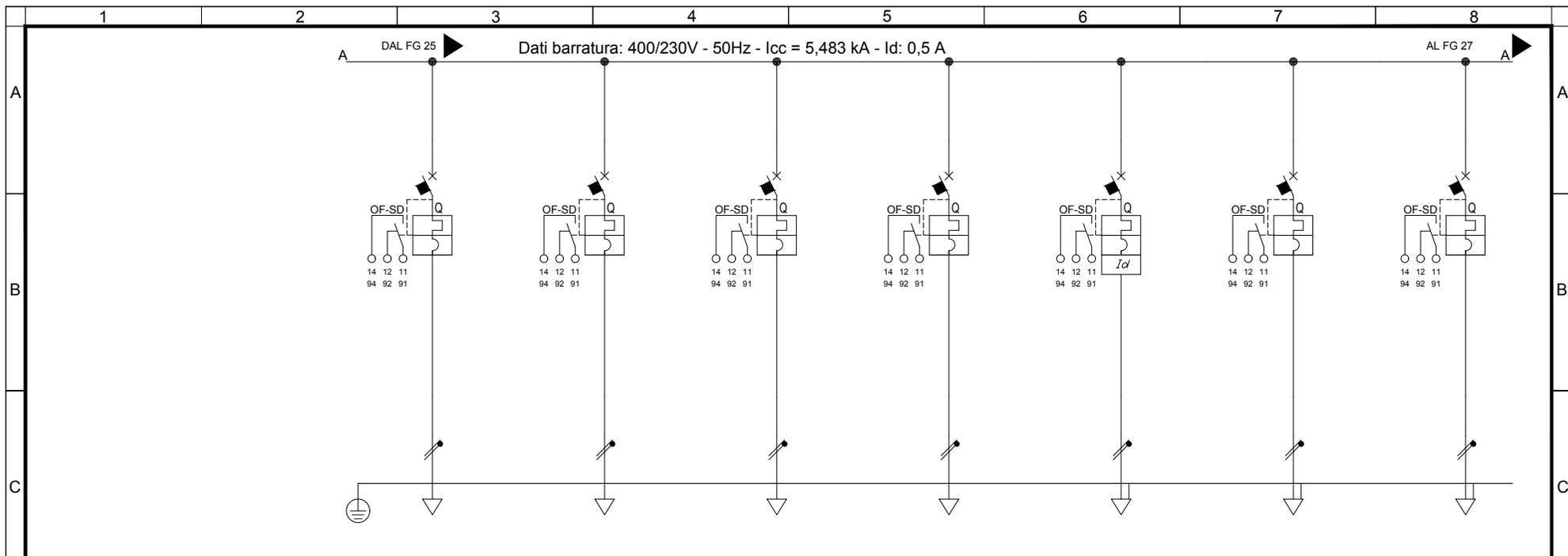
Dati barratura: 400/230V - 50Hz - I<sub>cc</sub> = 5,483 kA - I<sub>d</sub> = 0,5 A
