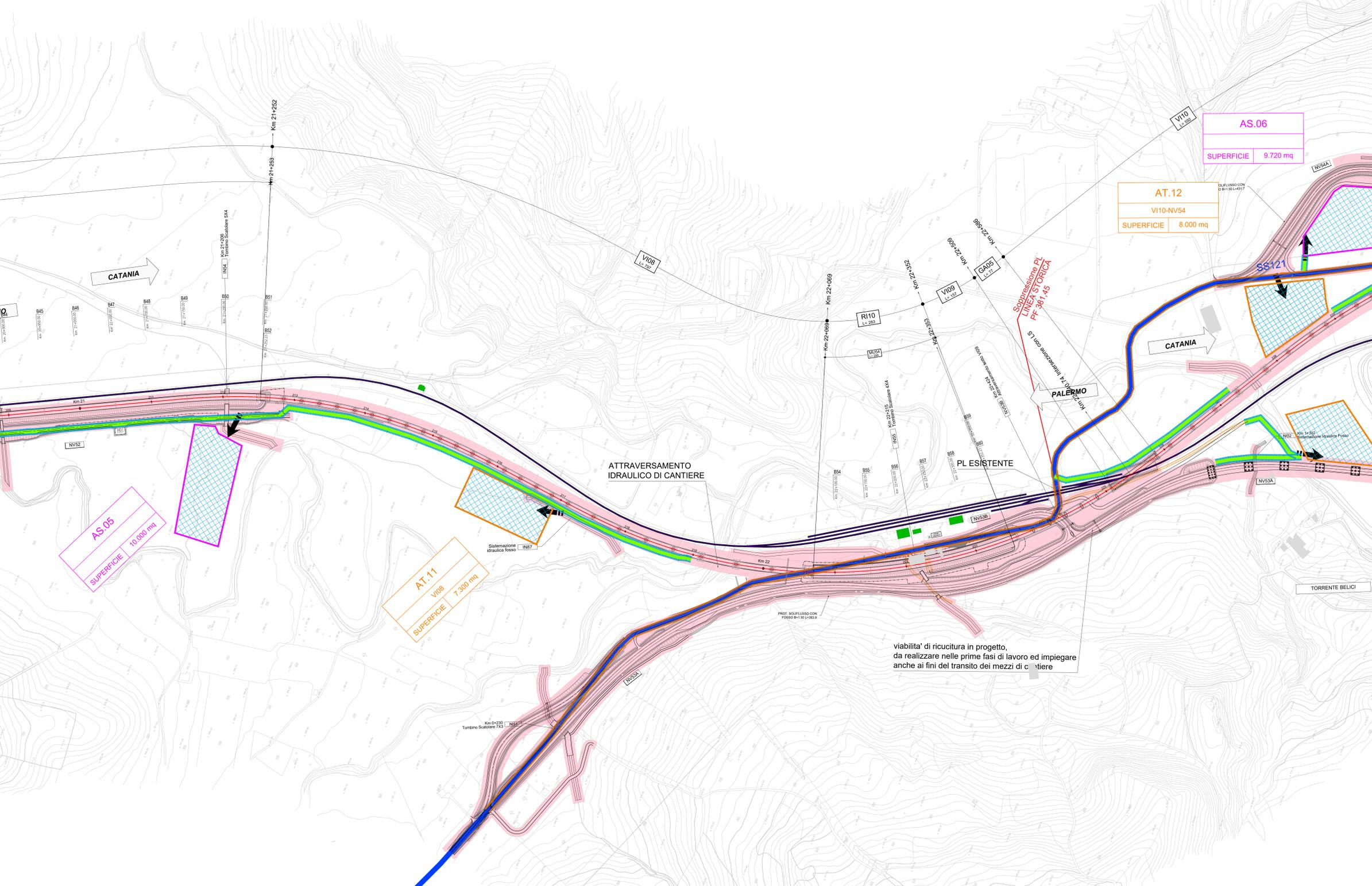
viabilità di ricucitura in progetto, da realizzare nelle prime fasi di lavoro ed impiegare anche ai fini del transito dei mezzi di cantiere
