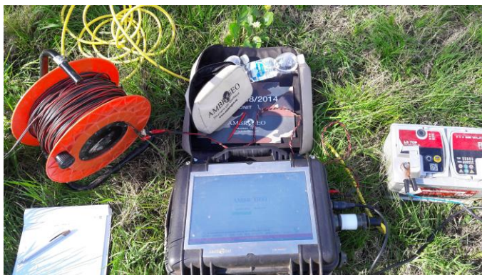
Figura 2: Sismografo digitale a 24 bit.
