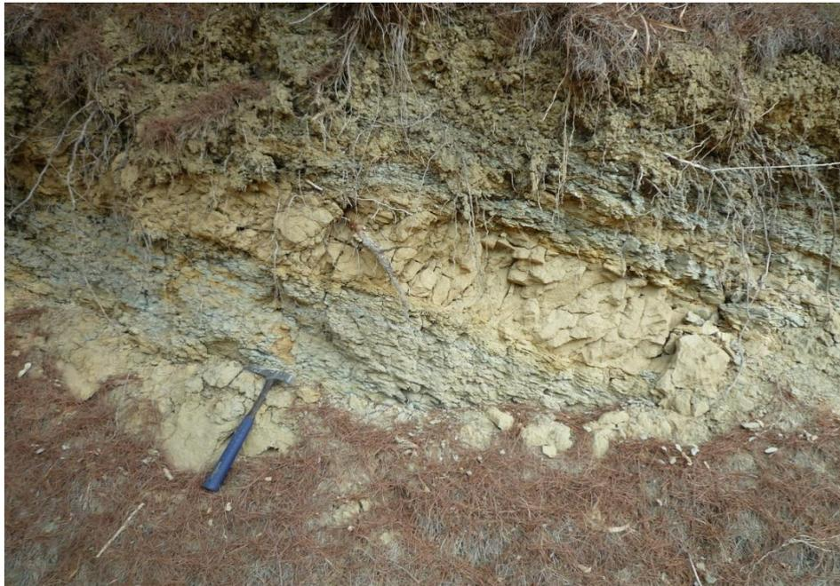
Alternanza di strati argilloso-marnosi a struttura scagliosa e strati sabbioso-arenacei fratturati
